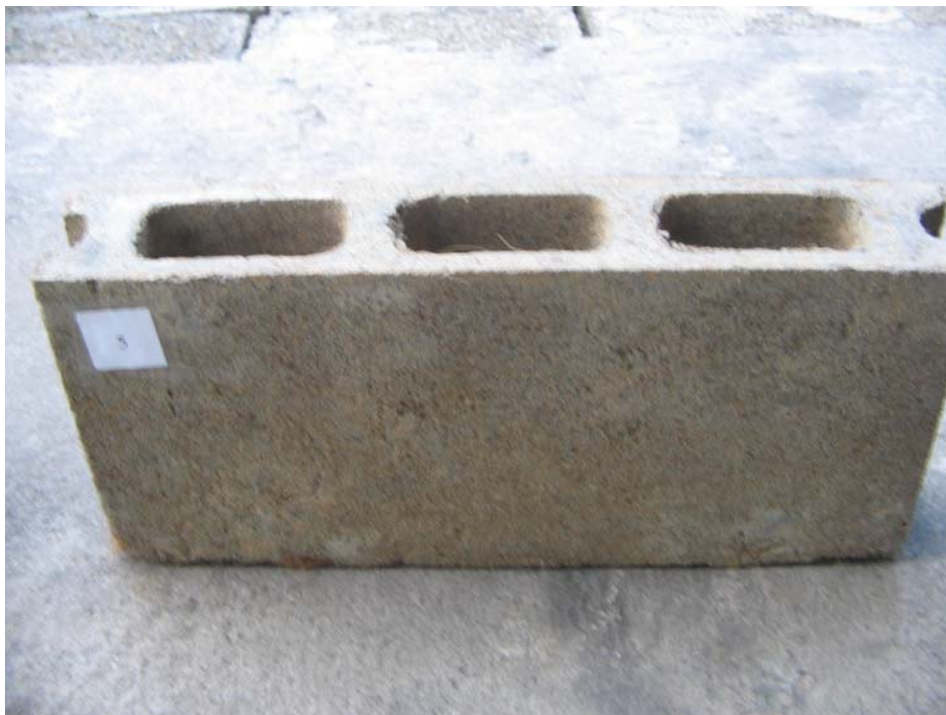
ก้อนคอนกรีตบล็อกสูตรที่ 5
