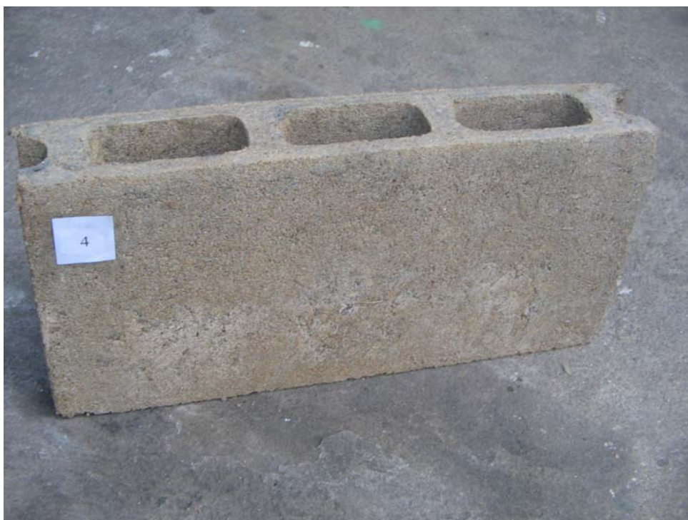
ก้อนคอนกรีตบล็อกสูตรที่ 4
