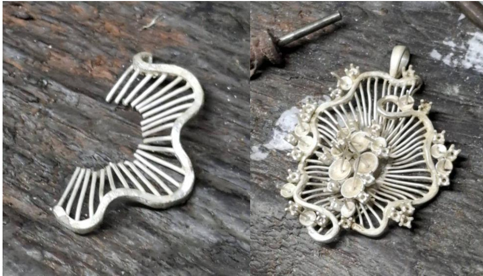
การเชื่อมประกอบตัวเรือน (ซ้าย) และตัวเรือนที่ประกอบสำเร็จก่อนฝังพลอย (ขวา)
