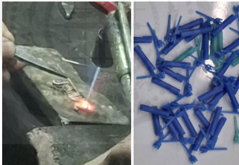
การเชื่อมประกอบตัวเรือน (ซ้าย) และชิ้นส่วนตัวเรือนและกระเปาะพลอยก่อนหล่อ (ขวา)
