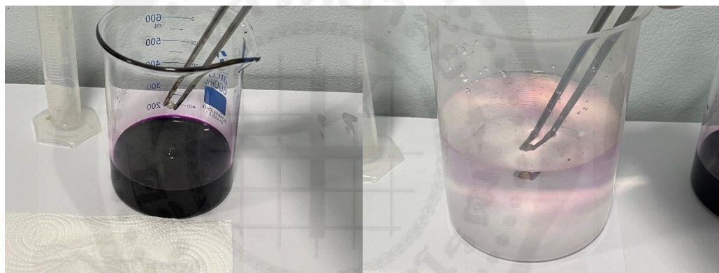
การย้อมไข่มุกด้วยสารละลายโพแทสเซียมเปอร์แมงกาเนต (ซ้าย) และการล้างทำความสะอาดด้วยน้ำเปล่า (ขวา)
