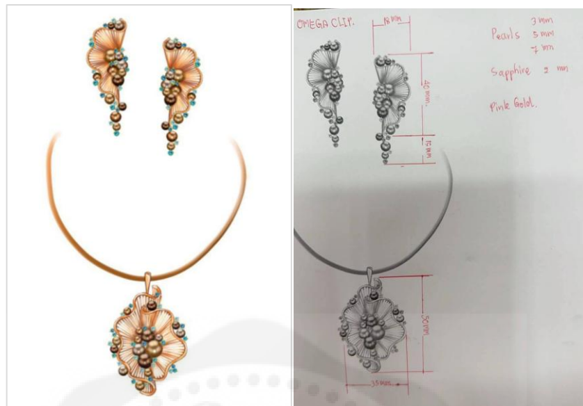
แบบร่าง (ซ้าย) และการกำหนดขนาดรายละเอียดชิ้นงานเพื่อการผลิต (ขวา)
