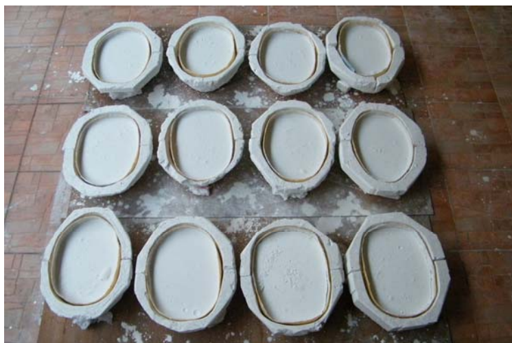
ภาพประกอบ 25 ขั้นตอนการเทปูนปลาสเตอร์ลงในแม่พิมพ์
