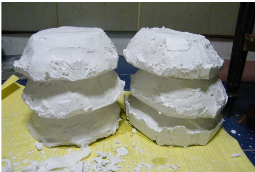
ภาพประกอบ 22 ขั้นตอนการตกแต่งพิมพ์ประกอบทำด้วยปูนปลาสเตอร์
