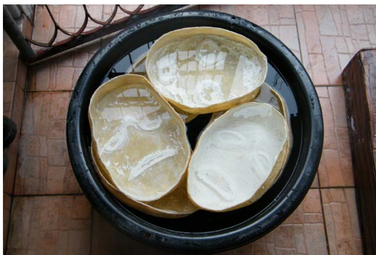
ภาพประกอบ 23 ขั้นตอนการแกะแม่พิมพ์ยางพาราออกจากตัวแบบ ล้างทำความสะอาด
