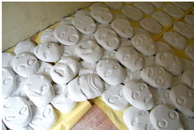
ภาพประกอบ 26 ขั้นตอนการแกะงานออกจากแม่พิมพ์
