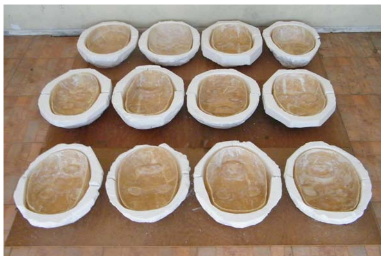
ภาพประกอบ 24 ขั้นตอนการตากแม่พิมพ์ที่เสร็จสมบูรณ์แล้ว
