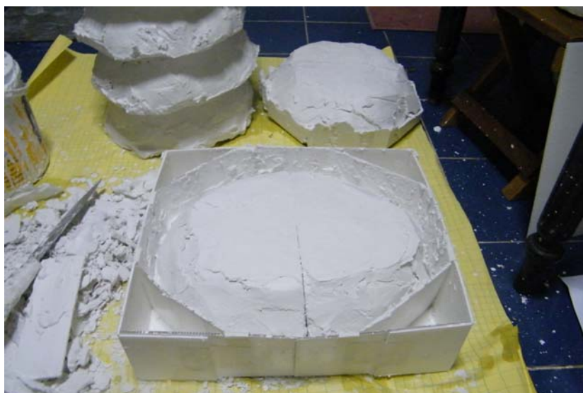
ภาพประกอบ 21 ขั้นตอนการทำพิมพ์ประกอบด้วยปูนปลาสเตอร์
