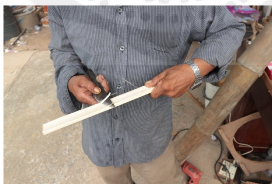
ภาพประกอบ 26 การตัดและตกแต่งไม้ไผ่ เพื่อทำลิ่มนิ้ว
