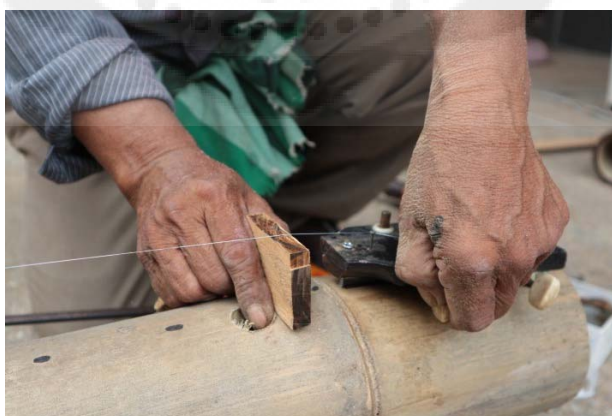
ภาพประกอบ 19 ประกอบโต๊ะพาดสาย
