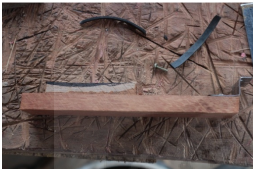
ภาพประกอบ 27 ติดไม้อัดไว้ด้านล่างของลิ่มไม้
