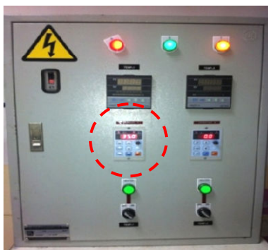
ภาพประกอบ 21 แสดงการเปิดสวิตช์มอเตอร์ควบคุมความเร็วในการยกชั้นข้าวเปลือก 140 rpm
