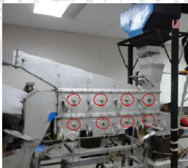
ภาพประกอบ 16 แสดงการติดตั้ง U-Tube มานอมิเตอร์กับห้องอบแห้งและห้องกระจายอากาศ
