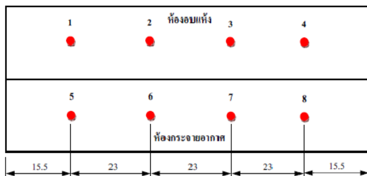
ภาพประกอบ 15 แสดงการติดตั้ง U-Tube มานอมิเตอร์ (cm)
