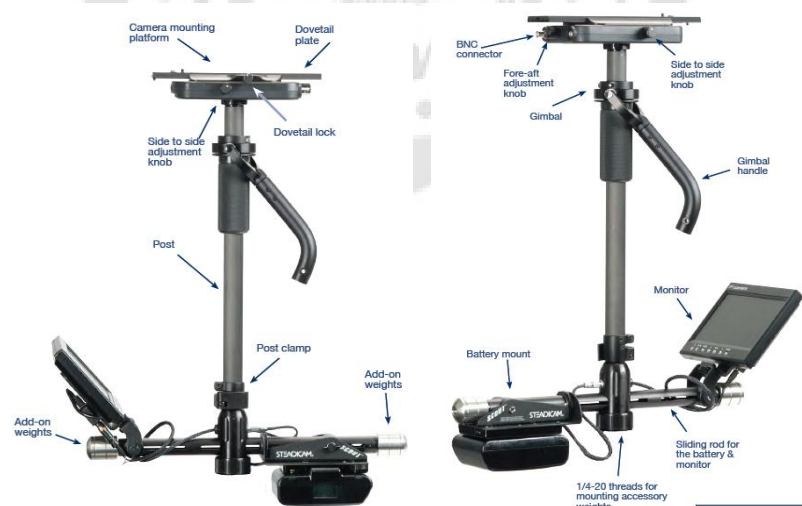
ภาพประกอบ 5 แสดงส่วนประกอบต่างๆ ของอุปกรณ์ลดการสั่นไหวของกล้อง
