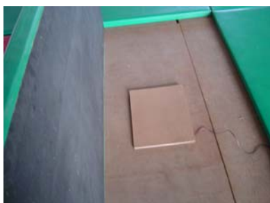
การวางแผ่นรับสัญญาณวางใต้เบาะยูโด
