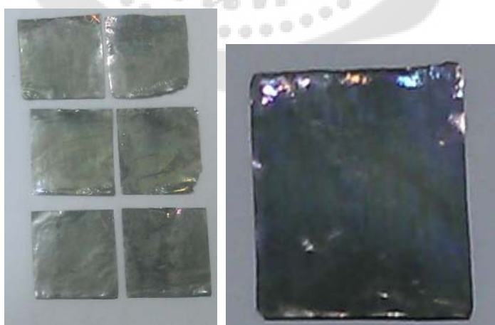
ภาพประกอบ 42 แผ่นเงินที่เคลือบด้วยบิสมาท์ที่อุณหภูมิ 400 องศาเซลเซียส
