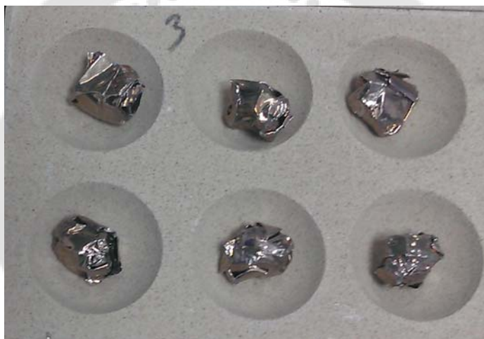
ภาพประกอบ 43 ตัวอย่างที่ห่อด้วยแผ่นเงินที่เคลือบด้วยบิสม์ที่อุณหภูมิ 300 องศาเซลเซียส
