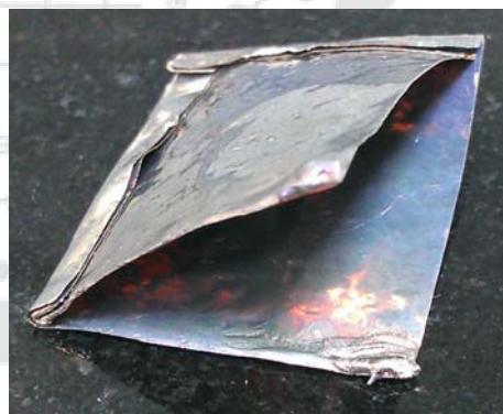
ภาพประกอบ 31 ลักษณะแผ่นเงินที่เคลือบด้วยบิสมัท 300 และ 400 องศาเซลเซียส
