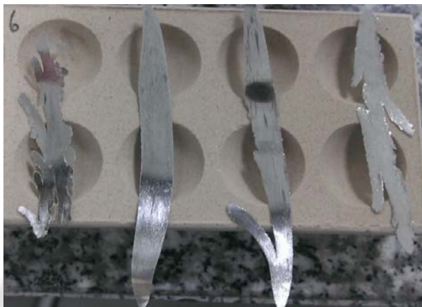
ภาพประกอบ 38 แสดงตัวอย่างที่ใช้อุณหภูมิ 1,000 องศาเซลเซียสที่เกิดการแตกในขณะรีด [12]
