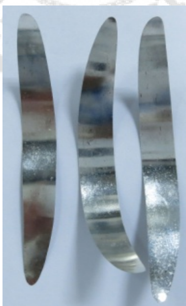
ภาพประกอบ 3 ลักษณะตัวอย่างที่รีดบางเพื่อนำไปทำ parting
