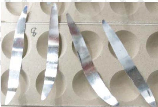
ภาพประกอบ 39 แสดงตัวอย่างที่ใช้อุณหภูมิ 1,050 องศาเซลเซียสที่ไม่เกิดการแตกในขณะรีด
