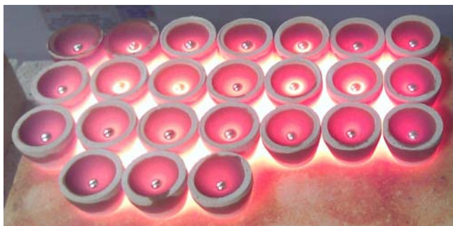
ภาพประกอบ 32 ลักษณะเม็ดโลหะหลังก้นำออกจากเตาหลอม
