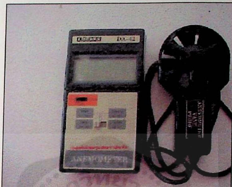
รูปภาพผนวกที่ 2.1 แสดงอุปกรณ์วัดความเร็วลม
