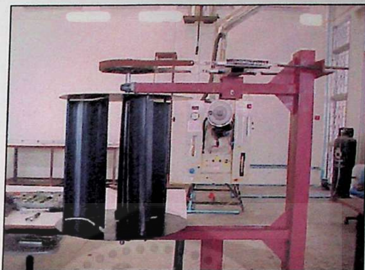
รูปภาพผนวกที่ 2.7 แสดงการติดตั้งกังหันลมเข้ากับแท่นทดสอบ
