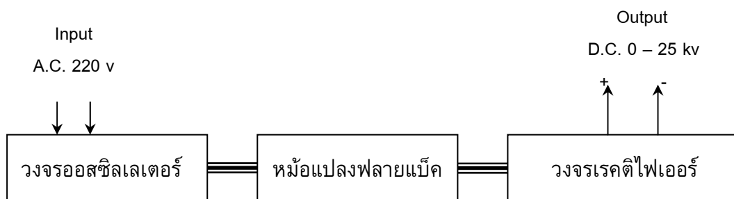
ภาพประกอบ 28 วงจรภายในเครื่องผลิตไฟฟ้าโวลต์เตจสูง
