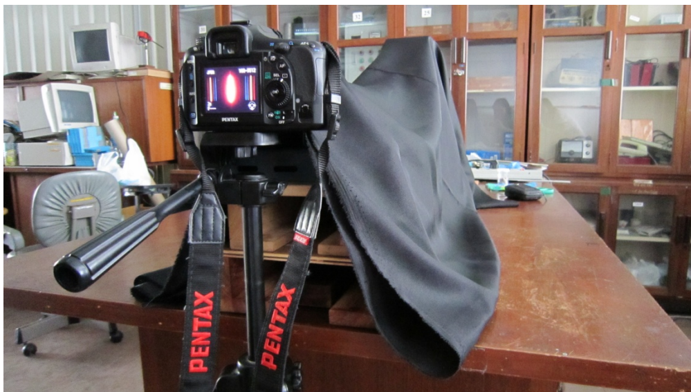
ภาพประกอบ 67 แสดงการถ่ายภาพสเปกตรัมแสงที่เลี้ยวเบนผ่านเกรตติงด้วยชุดอุปกรณ์
