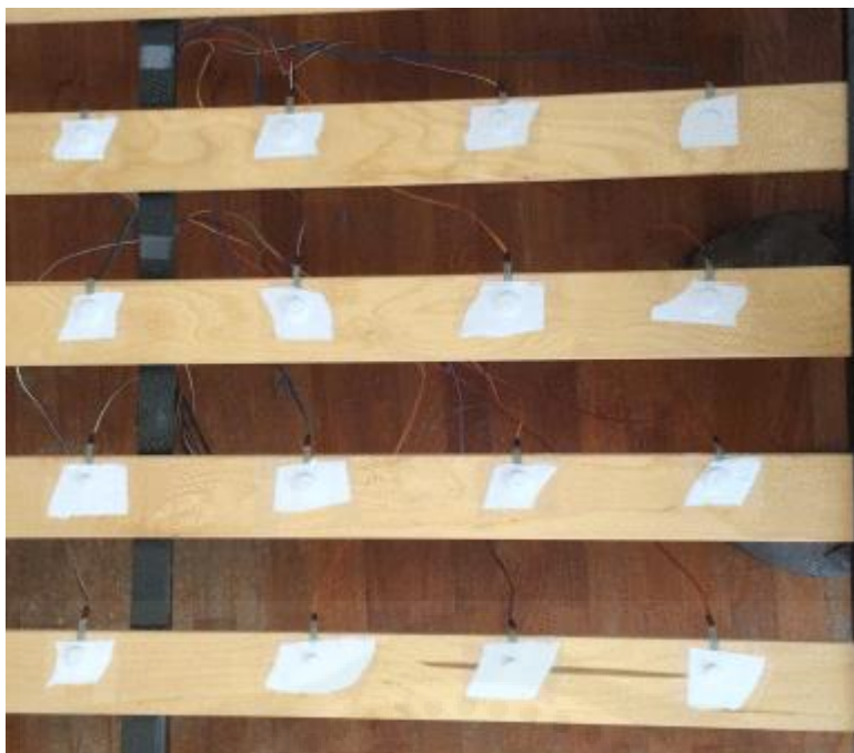
รูปภาพประกอบ 11 เซ็นเซอร์ตัวต้านทานการตรวจจับแรง (FSR) จะวางตารางบนคานของเตียง
