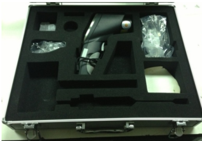
ภาพประกอบ 7 เครื่องวัดอุณหภูมิแบบอินฟราเรด
