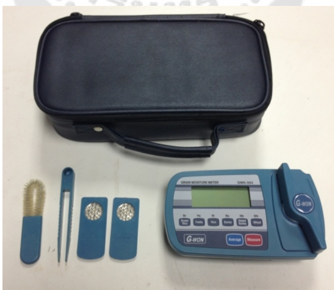
ภาพประกอบ 8 เครื่องวัดความชื้นเมล็ดข้าวเปลือก
