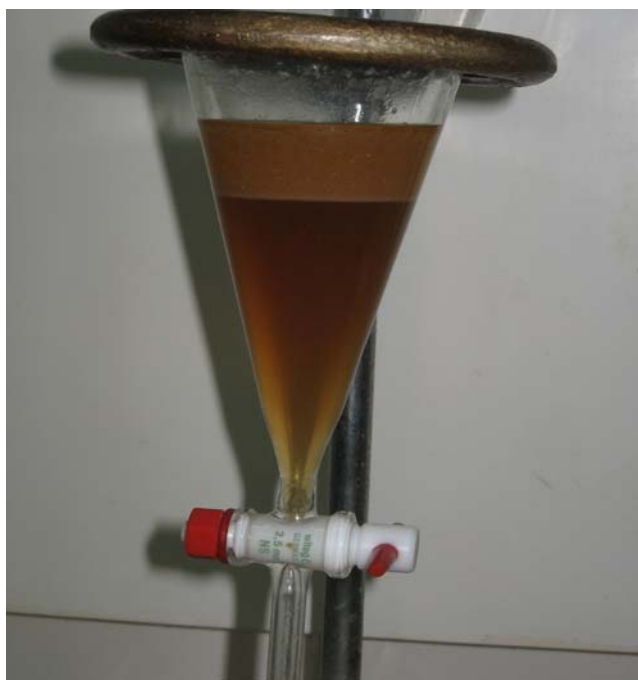
ภาพประกอบ 29 กลีเซอรินที่เกิดจากการใช้กรดซัลฟูริกเป็นตัวเร่งปฏิกิริยาที่ผ่านการปรับสภาวะให้เป็นกลางและสกัดด้วยเฮกเซน
