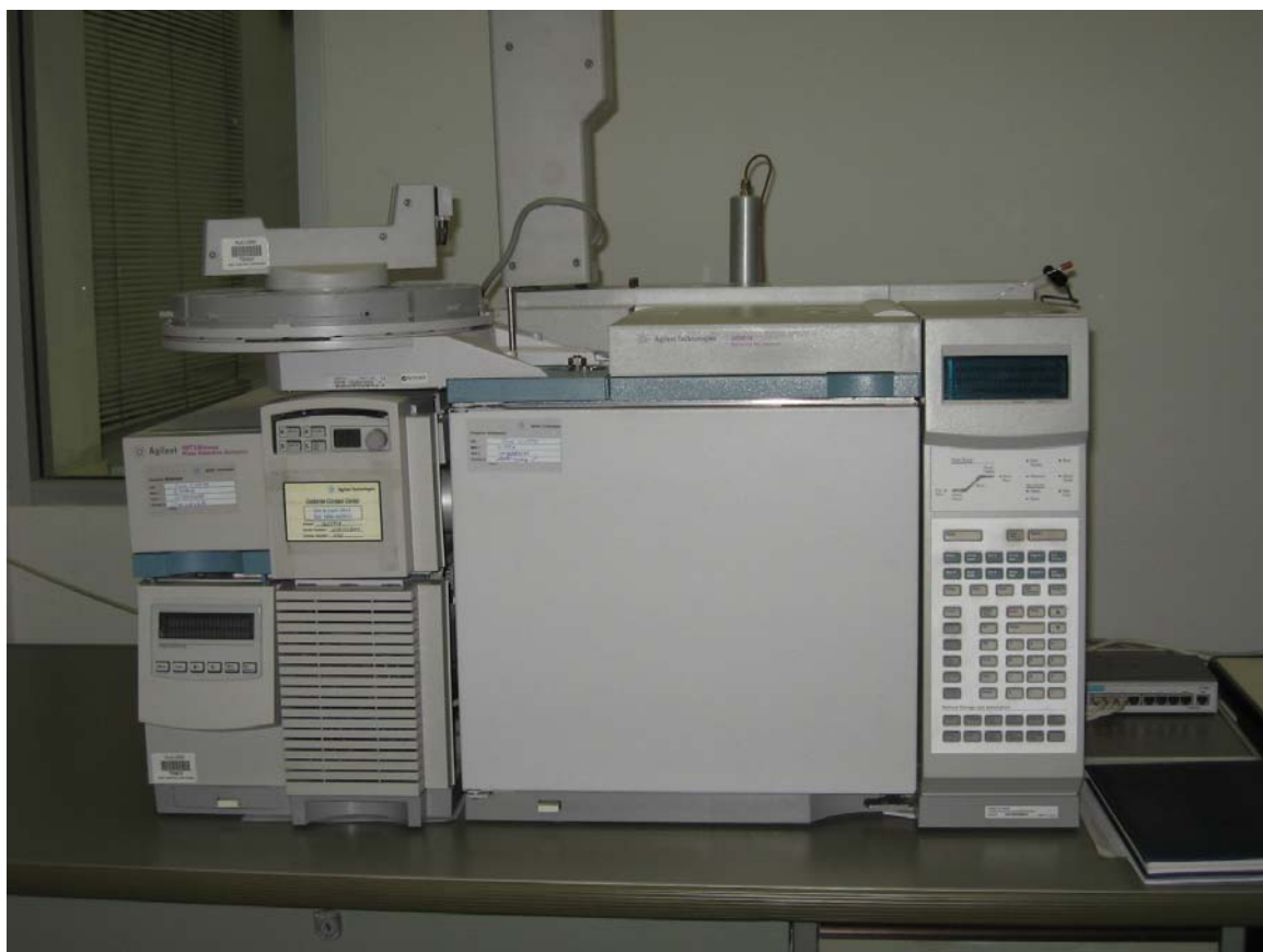
ภาพประกอบ 22 เครื่องแก๊สโครมาโทกราฟี แมสสเปกโตรมิเตอร์ ยี่ห้อ Agilent รุ่น 6890 N และ Agilent Mass Selective Detector 5973N
