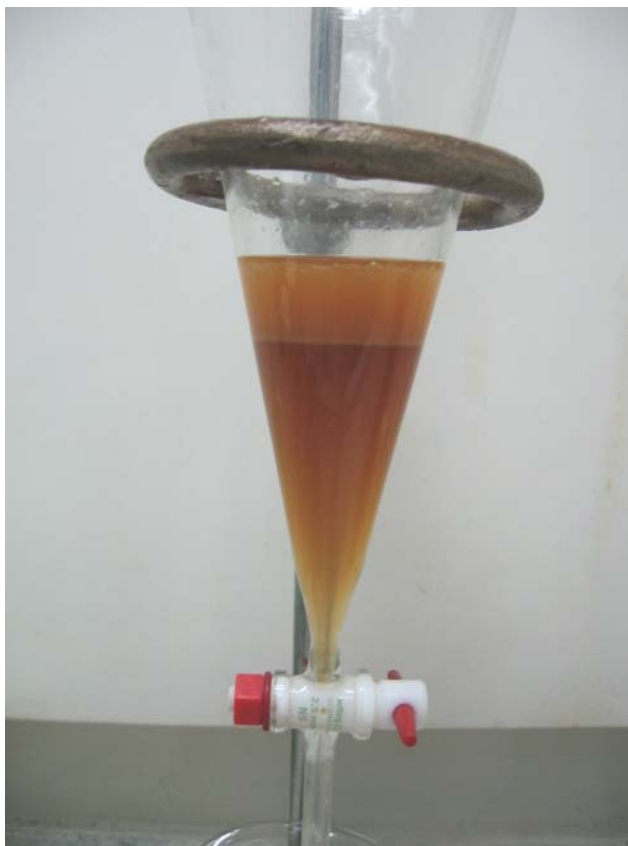
ภาพประกอบ 28 กลีเซอรินที่เกิดจากการใช้โปแตสเซียมไฮดรอกไซด์เป็นตัวเร่งปฏิกิริยาที่ผ่านการปรับสภาวะให้เป็นกลางและสกัดด้วยเฮกเซน
