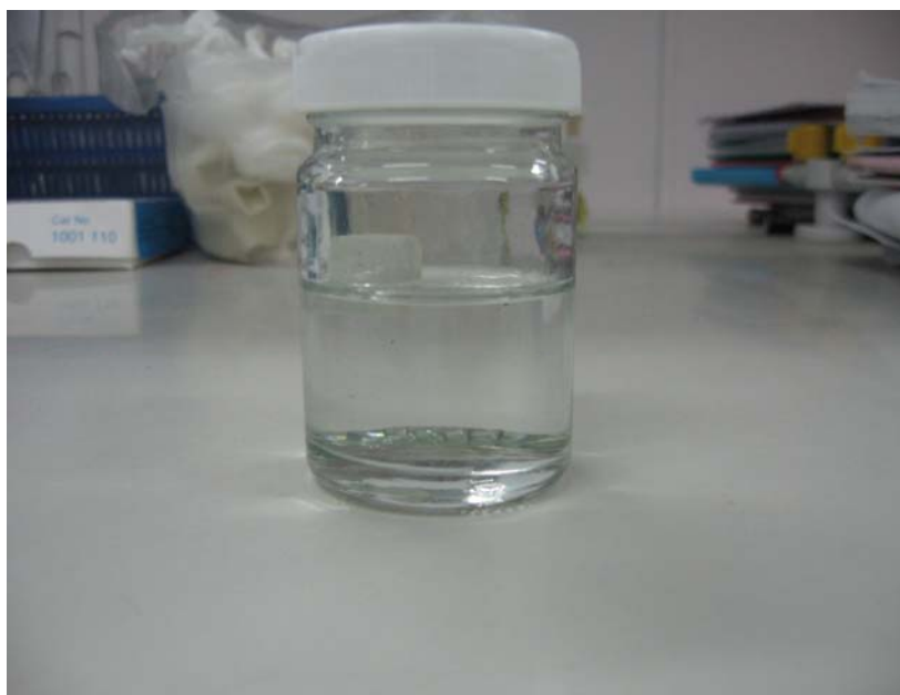
ภาพประกอบ 31 กลีเซอรินบริสุทธิ์ที่ได้จากการกำจัดสี กลั่นด้วยดินเบนทอไนต์
