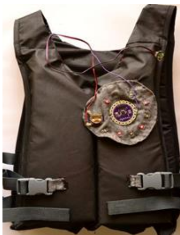
รูปที่ 2-6 เสื้อชูชีพ (Life Jacket) ที่เชื่อมต่อกับ LilyPad และไฟ LED
