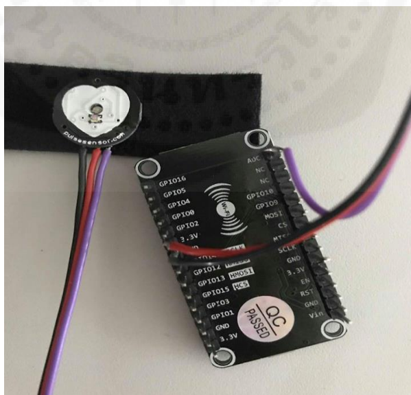
รูปที่ 3-1 วงจรการเชื่อมต่อ NodeMCU กับ Pulse Sensor
