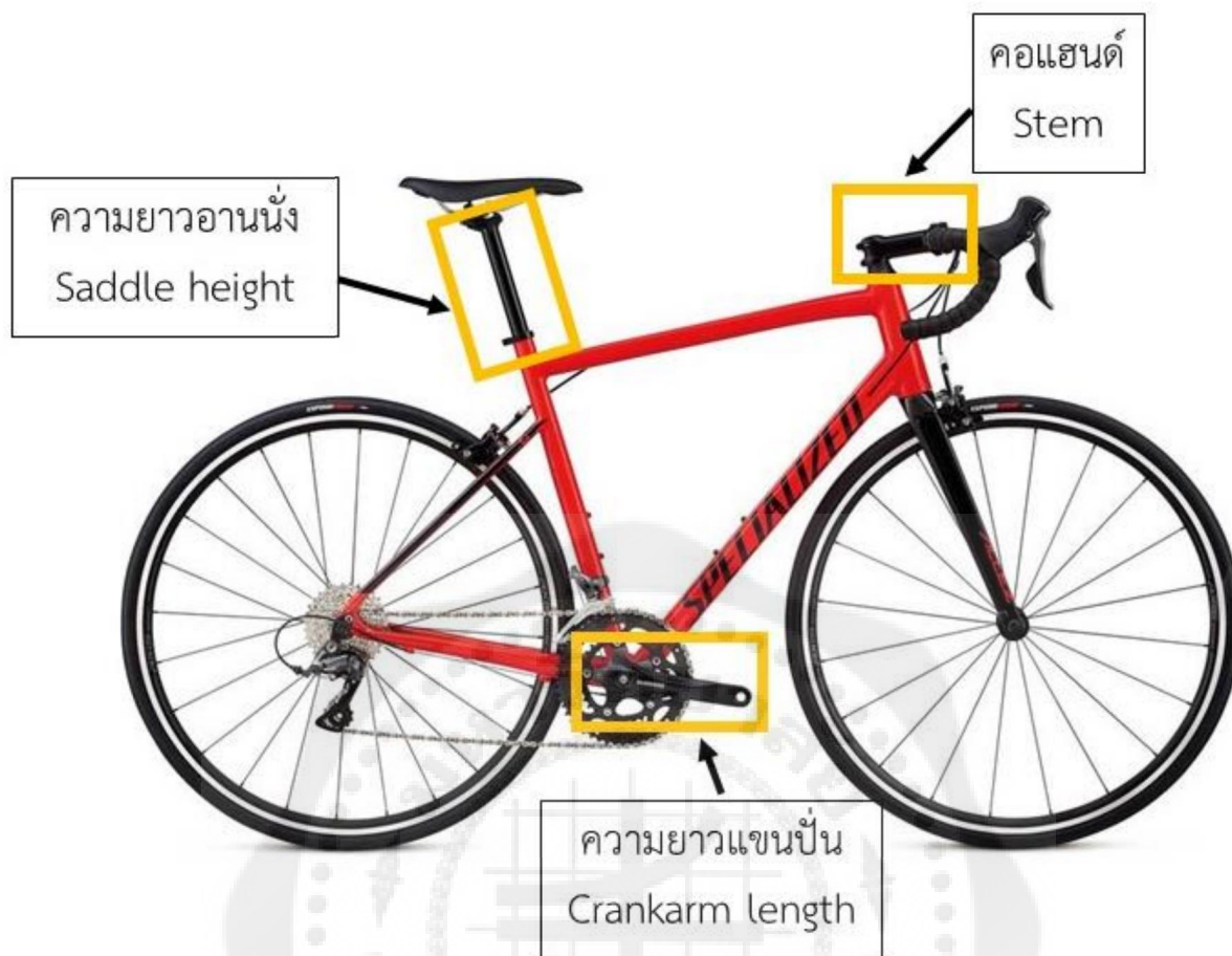
ภาพที่ 3.29 ส่วนประกอบสำหรับการติดตั้ง (fitting) จักรยานเสือหมอบ
