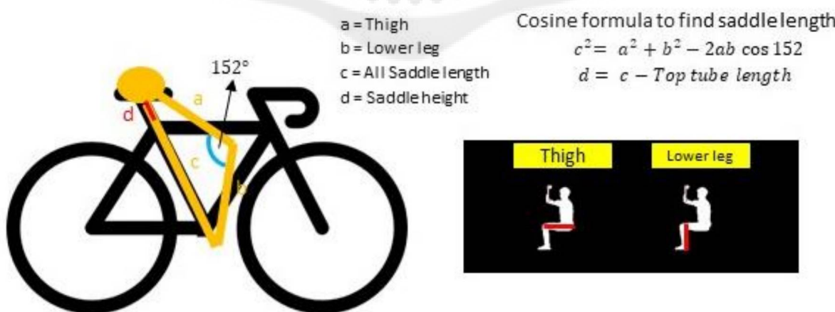
ภาพที่ 4.4 กระบวนการหาความยาวของอานนั้น (Saddle height)
