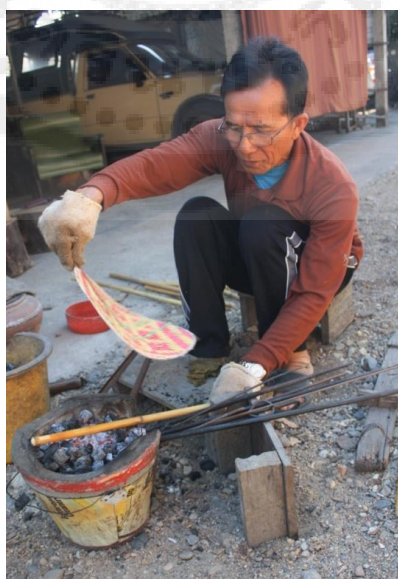
ภาพประกอบ 19 พ่อครูก้วนดกำลังนำเลาปีลงไฟก่อนทำการตัดให้ตรง
