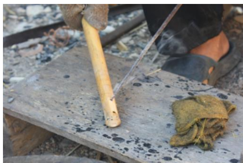
ภาพประกอบ 18 พ่อครูก้วนดากำลังใช้เหล็กร้อนเจาะรูระบายความร้อนภายในเลาปี
