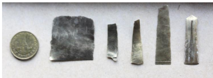
ภาพประกอบ 24 เหรียญที่นำมาตีเป็นล้นปีในแต่ละขั้นตอน
