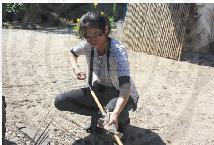
ภาพประกอบ 22 ผู้วิจัยได้ทดลองทำขั้นตอนการทะลวงช่องกลางของไม้รวก
