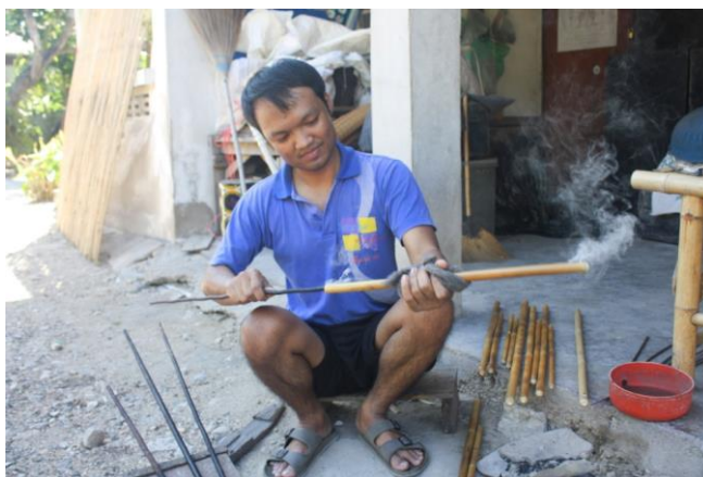
ภาพประกอบ 21 นายวิทวัส ทีโน ทำการสาธิตการทะลวงช่องกลางของไม้รวก
