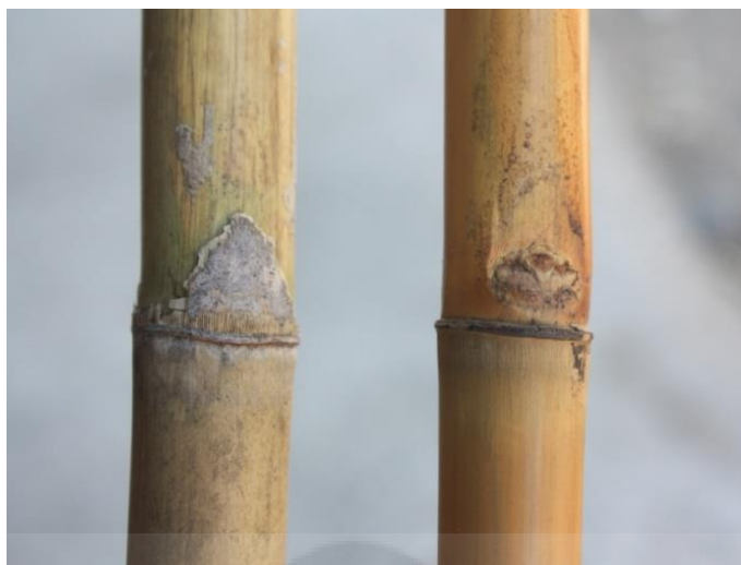
ภาพประกอบ 12 ภาพไม้รวกก่อนและหลังริดข้อออก
