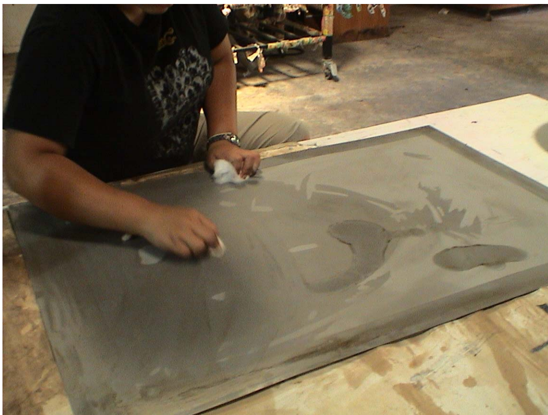
ภาพประกอบ 36 – 37 การล้างเขม่าและวัสดุไซบอนแม่พิมพ์
