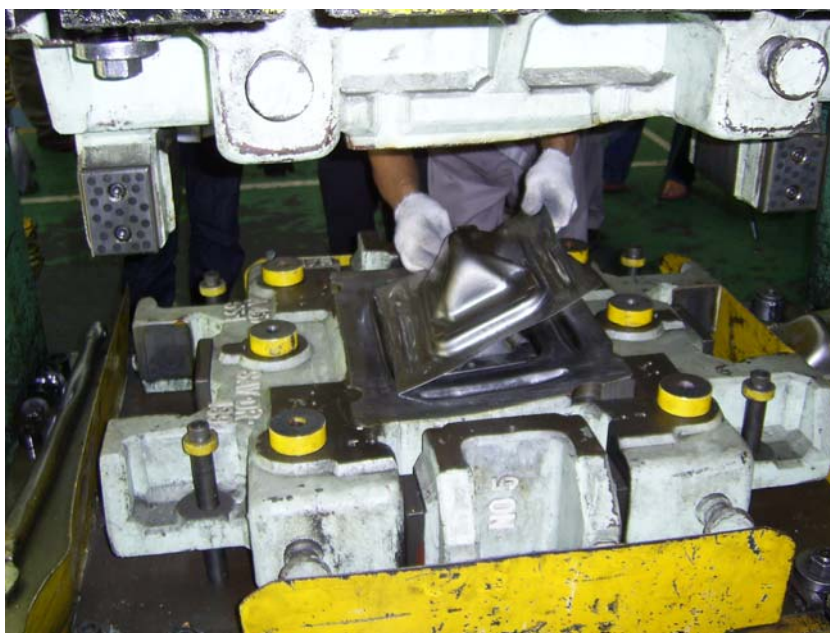
ภาพประกอบ 64 แม่พิมพ์ตัวถังรถยนต์ด้านใน ขั้นตอน Draw 2
