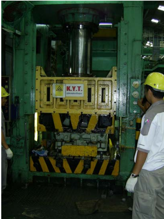
ภาพประกอบ 62 เครื่องเพรสไฮดรอลิก ขนาด 300 ตัน
