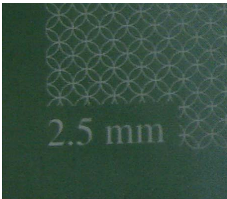
ภาพประกอบ 52 รูปร่างและขนาดของกริดวงกลมเส้นผ่านศูนย์กลาง 2.5 mm.
