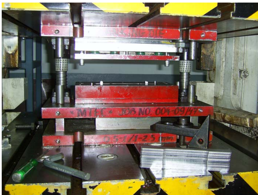
ภาพประกอบ 60 แม่พิมพ์ขึ้นทดสอบ(Specimen)ตามมาตรฐาน ASTM E8 M
