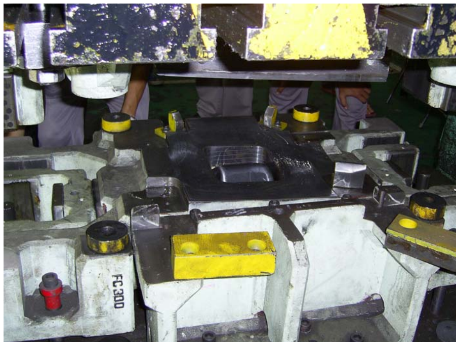
ภาพประกอบ 63 แม่พิมพ์ตัวถังรถยนต์ด้านใน ขั้นตอน Draw 1
