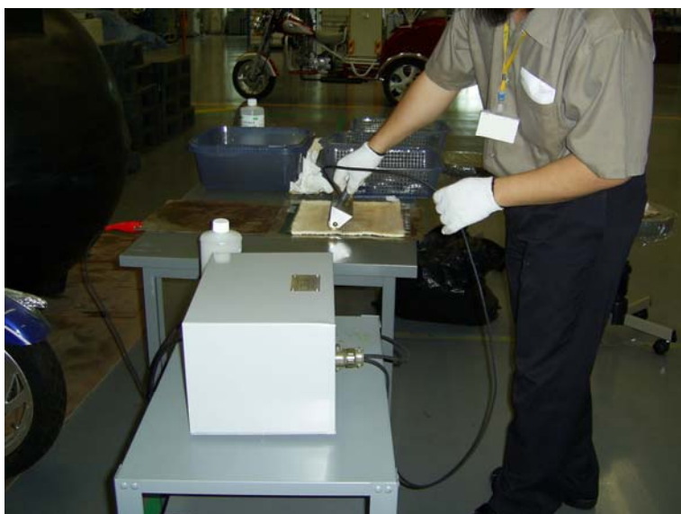
ภาพประกอบ 57 ลักษณะการขึ้นรูปกิริตวงกลมโดยใช้ลูกกลิ้งกด
