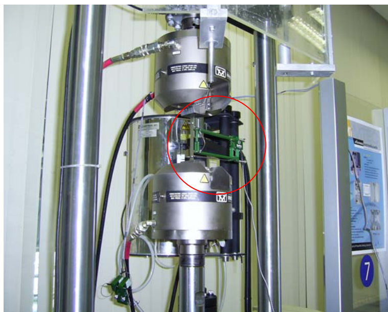
ภาพประกอบ 49 การติดตั้งเอ็กซ์เทนโซมิเตอร์(Extensometer)
