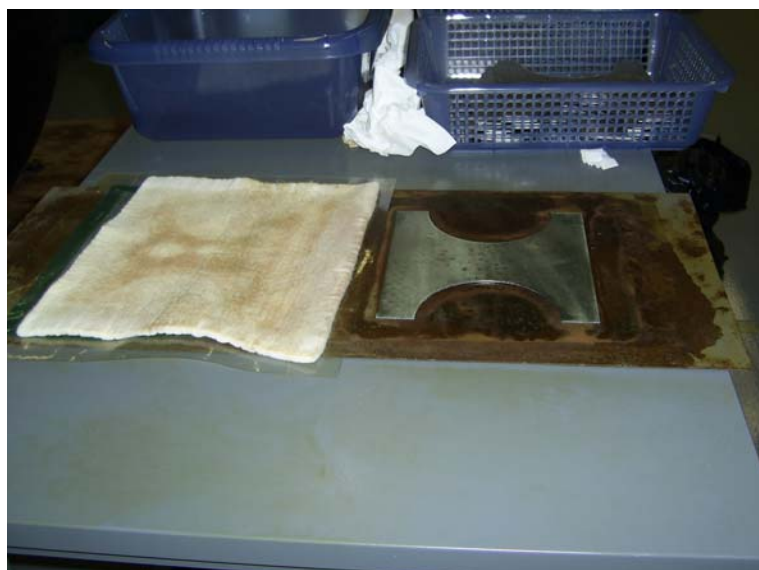
ภาพประกอบ 55 ลักษณะการวางชิ้นงานเพื่อตีกริดวงกลม
