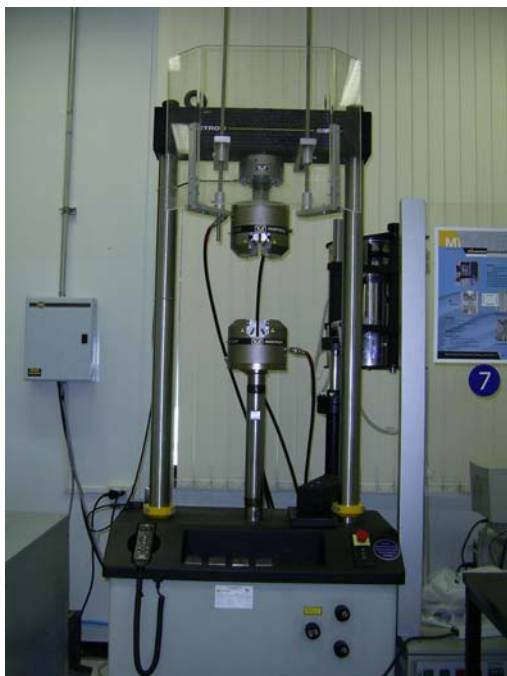
ภาพประกอบ 45 เครื่องทดสอบอเนกประสงค์ แบบพลวัต(Universal test machine, Dynamic type) ยี่ห้อ INSTRON รุ่น 8801
