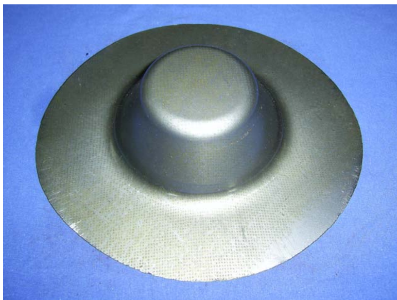
ภาพประกอบ 77 ชิ้นงานรูปถ้วยทรงกรวยหนา 0.8 mm.
