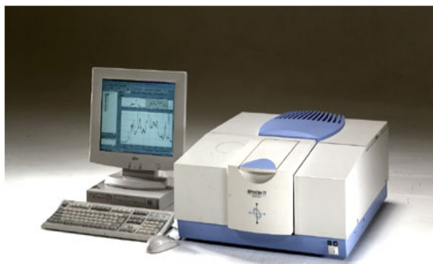
ภาพประกอบ 8 ตัวอย่างเครื่องฟูเรียร์ทรานส์ฟอร์ม อินฟราเรดสเปกโตรสโคปี
