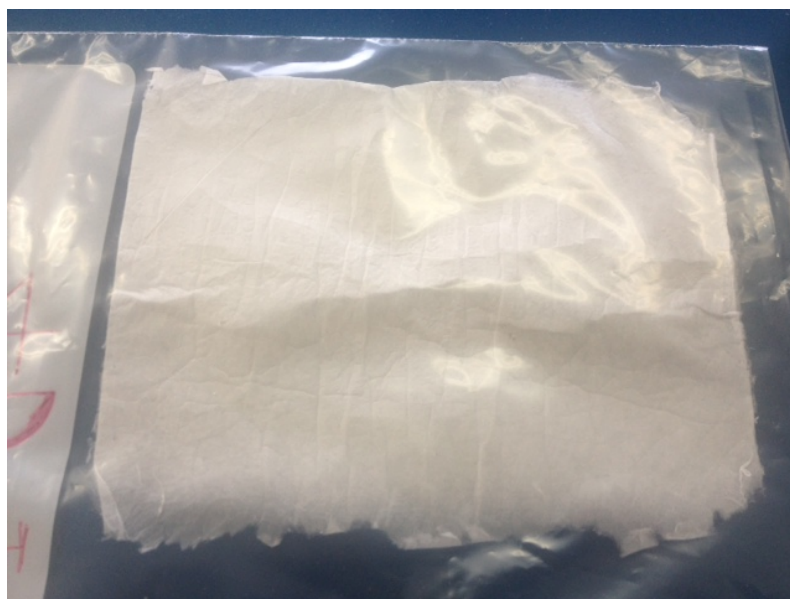
ภาพประกอบ 16 แผ่นเส้นใยซิลิกาที่ได้จากการปั่นเส้นใยด้วยไฟฟ้าสถิต
