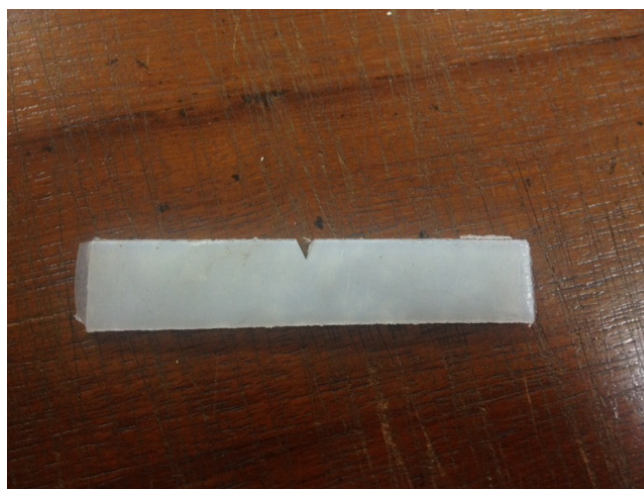
ภาพประกอบ 22 ชิ้นงานสำหรับการทดสอบการรับแรงกระแทกที่ทำรอยบากแล้ว
