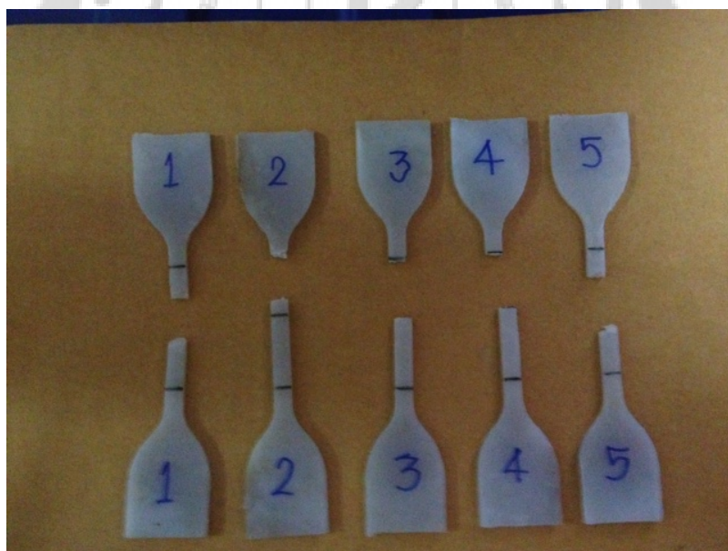
ภาพประกอบ 56 ชิ้นงานแบบประกบ 3 ชั้น TSB-1 หลังการทดสอบแรงดึง ทั้ง 5 ชิ้นงาน
