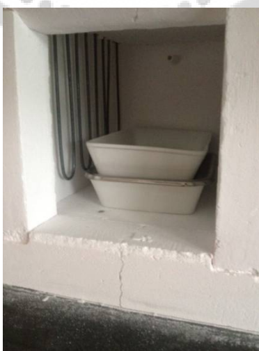
ภาพประกอบ 15 เส้นใยซิลิกาเผาด้วยเตาเผาอุณหภูมิสูงสำหรับวัสดุเซรามิก
