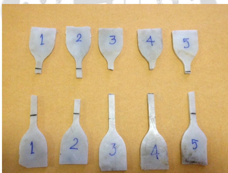
ภาพประกอบ 54 ชิ้นงานแบบประกบ 2 ชั้น TSA-2 หลังการทดสอบแรงดึง ทั้ง 5 ชิ้นงาน
