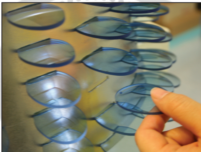
ภาพประกอบ 27 การเสียบเลนส์เพื่อประกอบเข้ากับโครงสร้าง
