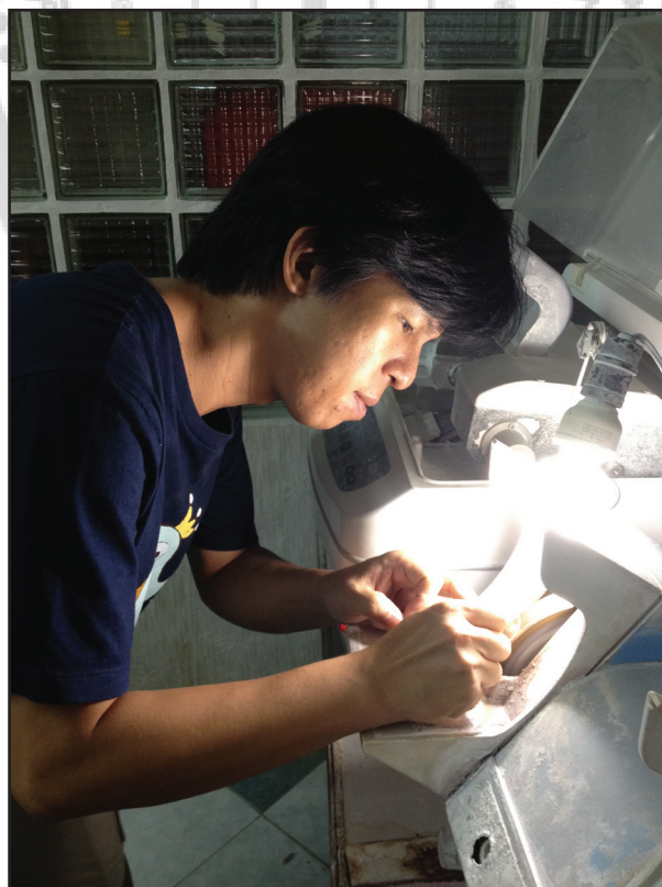
ภาพประกอบ 21 ขั้นตอนการฟนเลนส์ด้วยเครื่องฟนเลนส์
