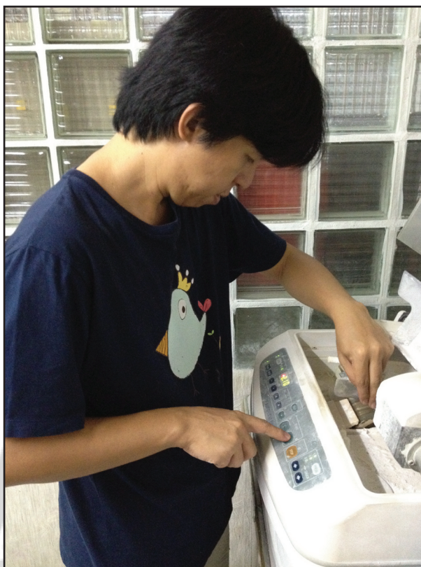
ภาพประกอบ 20 การตั้งเครื่องฟนเลนส์อัตโนมัติ
