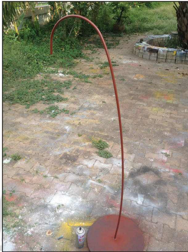
ภาพประกอบ 15 ฟันสีกันสนิมที่โครงสร้างของโคมไฟ
