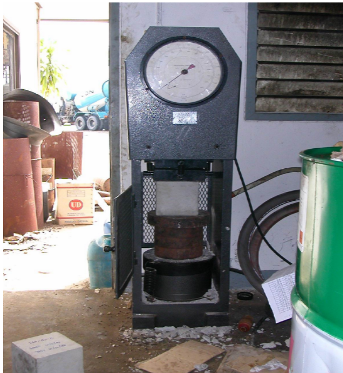
ภาพแสดงเครื่องมือทดสอบกำลังอัดของมวลคอนกรีตล้นแบบทำลาย
