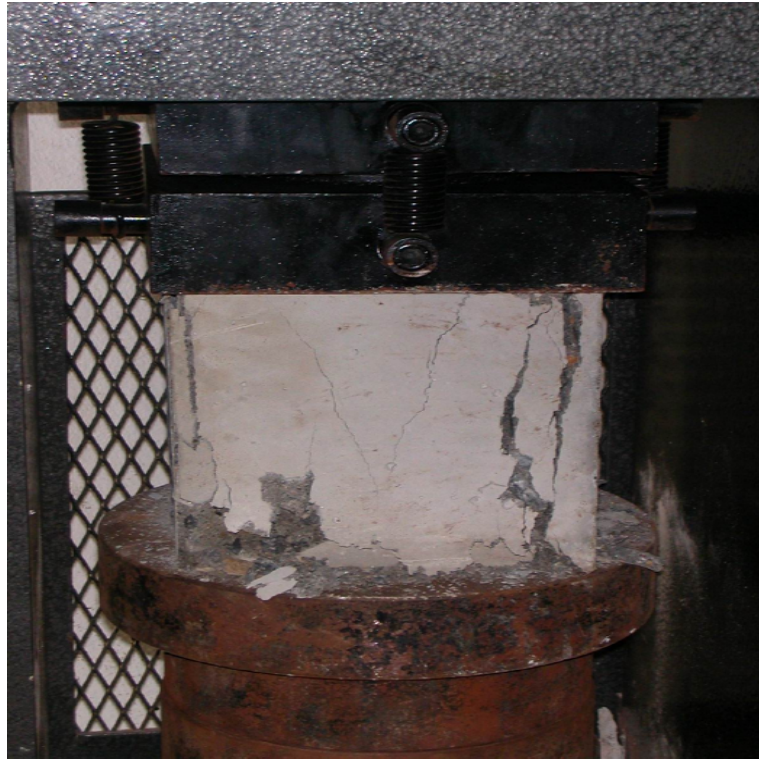
ภาพแสดงเครื่องมือทดสอบกำลังอัดของมวลคอนกรีตล้นแบบทำลาย
