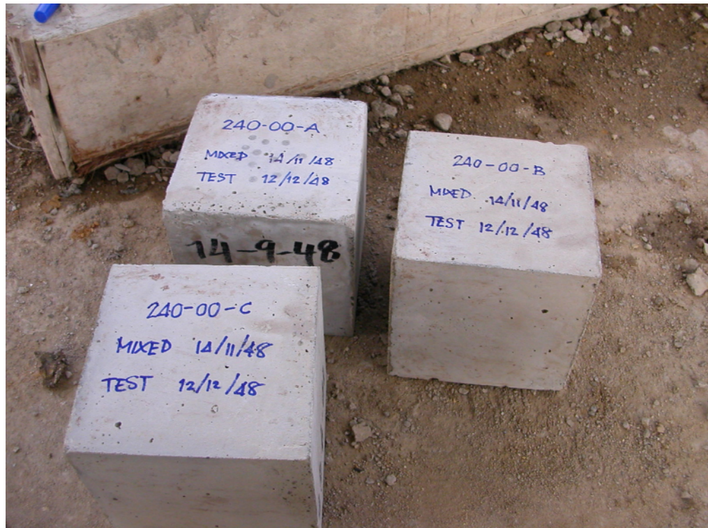
ภาพแสดงการมวลคอนกรีตลั่ว้น ที่ทำการกำหนดหมายเลขสำหรับการทดสอบ
