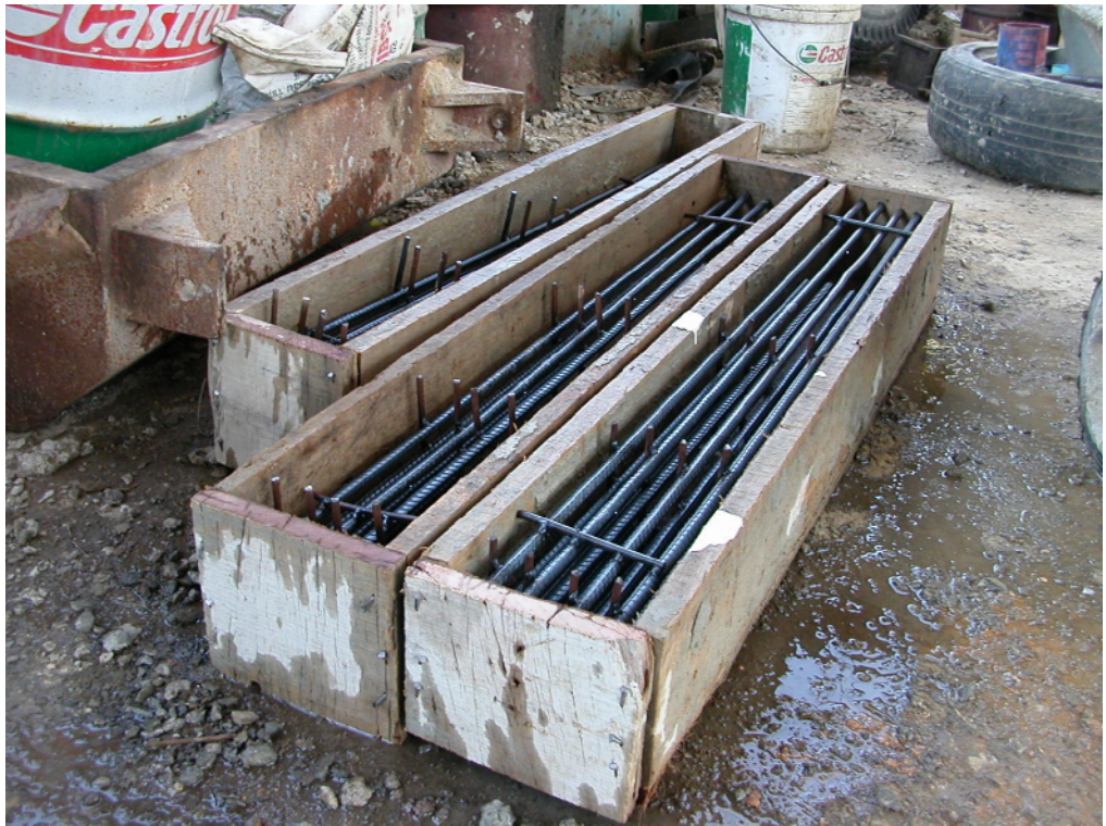
ภาพแสดงการเตรียมเหล็กเสริมในตัวอย่างทดสอบ
