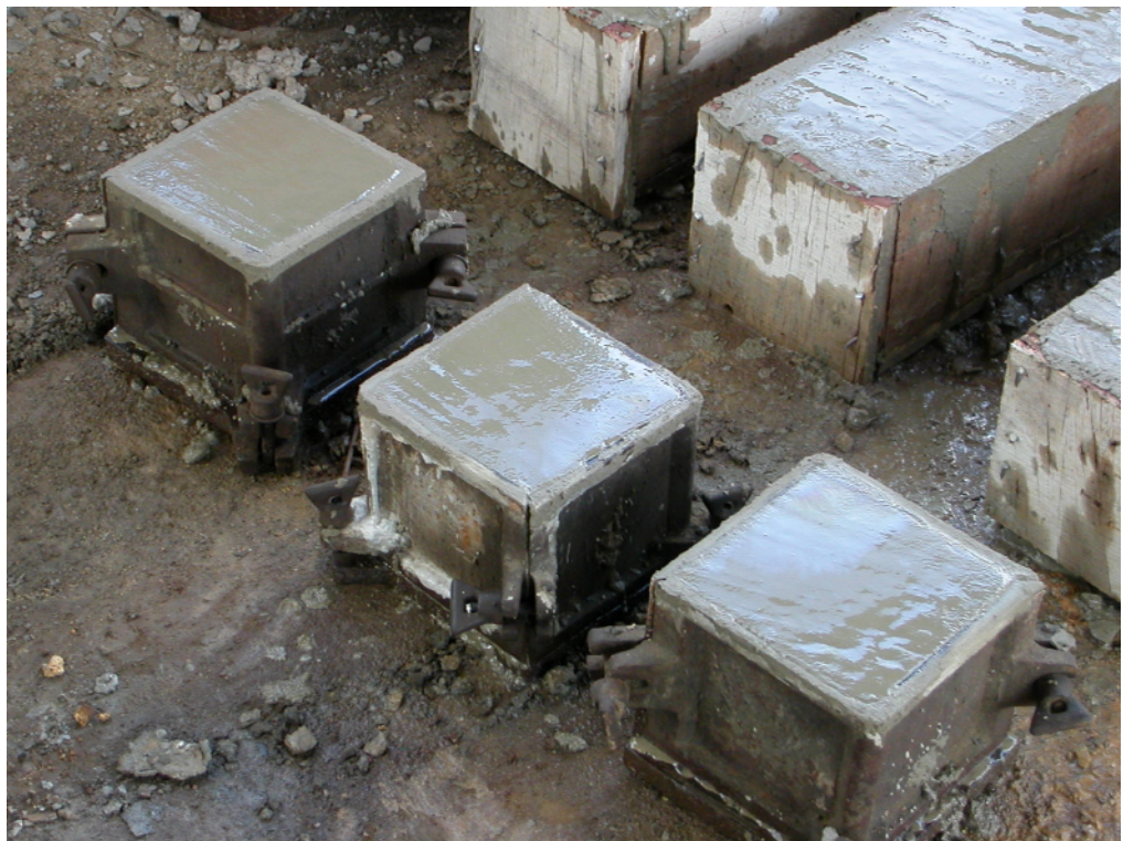
ภาพแสดงการเตรียมมวลคอนกรีตล้นในแบบหล่อทดสอบมาตรฐาน
