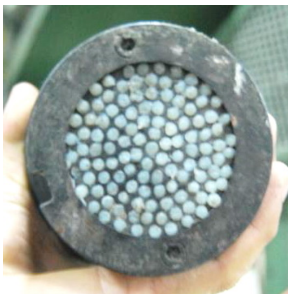
ภาพประกอบ 24 อะแดปเตอร์ตัวรองรับตะแกรง
