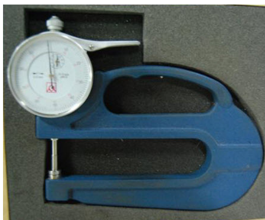
ภาพประกอบ 55 เครื่องมือวัดความหนา-บาง (Thickness Gauge) ของถุงพลาสติก
