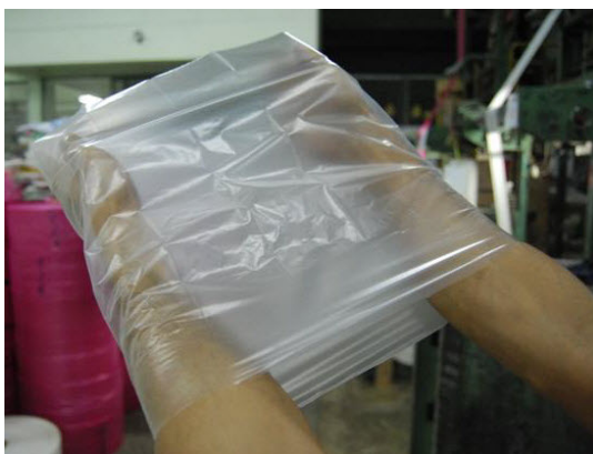
ภาพประกอบ 57 ขณะทำการทดสอบความเหนียวของถุงพลาสติก
