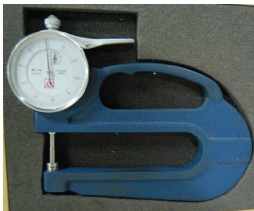
ภาพประกอบ 56 เครื่องมือวัดความหนา-บาง (Thickness Gauge)6
