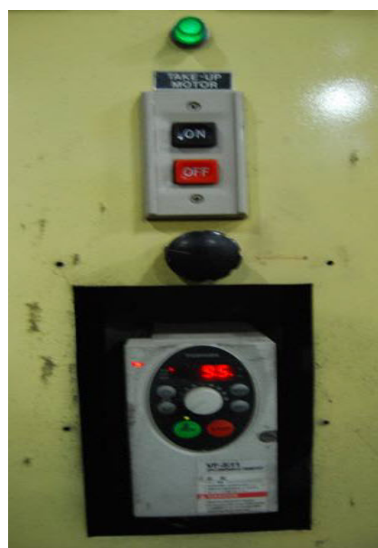
ภาพประกอบ 50 อินเวอร์สเตอร์ควบคุมลูกกลิ้งชุดบนพร้อมสวิตช์ควบคุม
