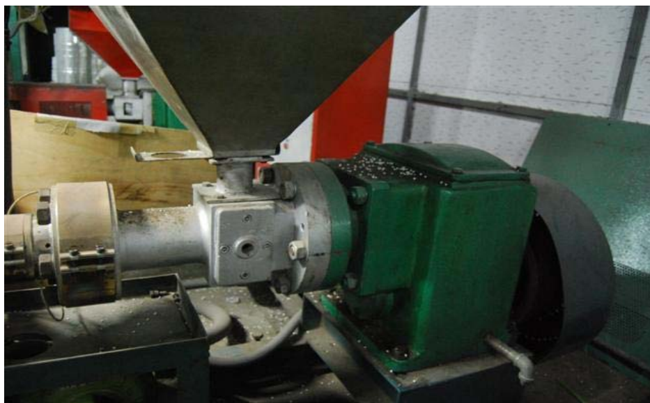
ภาพประกอบ 26 ชุดรองรับแรงเนื่องจากความดันของพลาสติกหลอม
