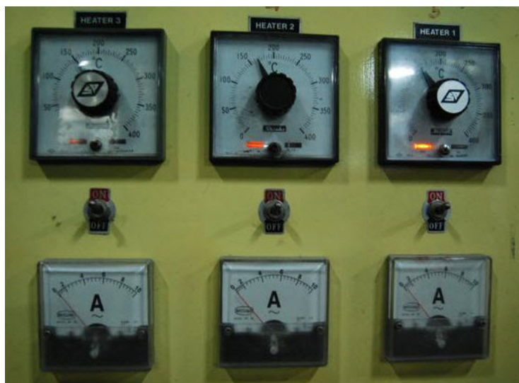
ภาพประกอบ 48 ชุดปรับอุณหภูมิแผ่นความร้อนบริเวณกระบอกลและมาตรวัดอุณหภูมิแผ่นความร้อน
