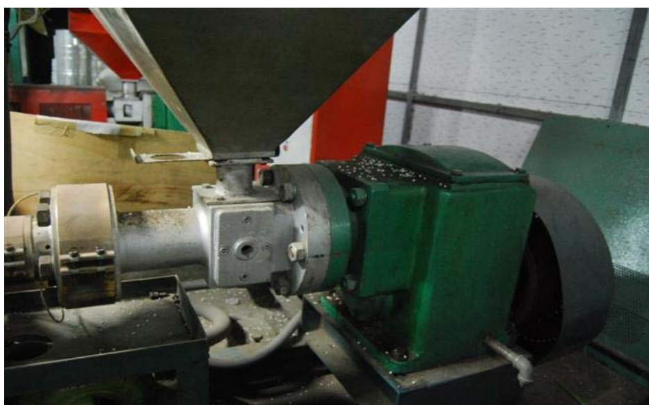
ภาพประกอบ 26 ชุดรองรับแรงเนื่องจากความดันของพลาสติกหลอม
