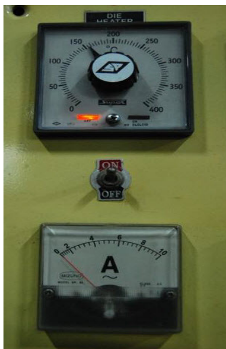
ภาพประกอบ 47 ชุดปรับอุณหภูมิหัวตายและมาตรวัดอุณหภูมิหัวตาย
