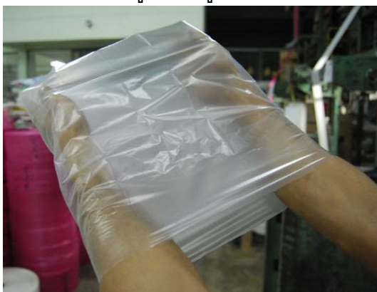
ภาพประกอบ 58 ขณะทำการทดสอบความเหนียวของถุงพลาสติก
