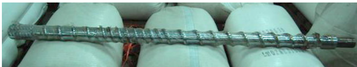
ภาพประกอบ 15 สกรูเครื่องเอกซ์ทรูดแบบสกรูเดี่ยว
