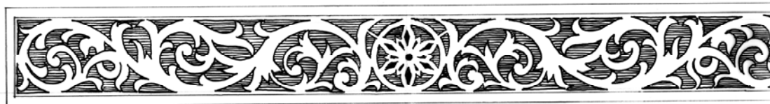
ภาพประกอบ 71 ภาพแสดงไม้ฉลุลายแบบเครือเถาในแนวนอนที่วางในตำแหน่งคอสอง
