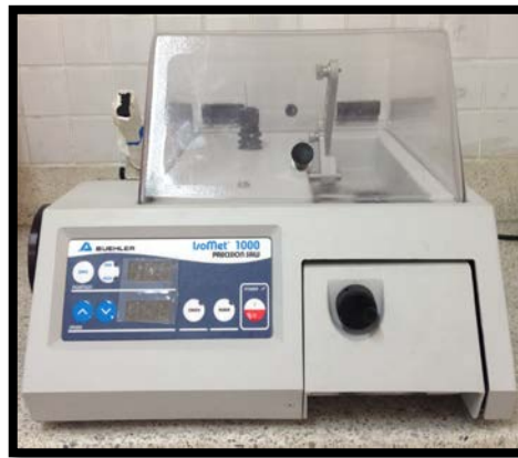
ภาพประกอบ 10 เครื่องตัดฟันชนิดไบเลื่อยกากเพชรความเร็วรอบต่ำ (low speed diamond saw: ISOMET 1000, Buehler Ltd., Lake bluff, IL, USA)
