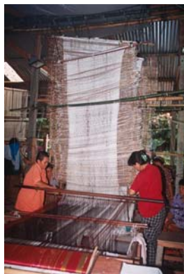
เริ่มเก็บตะกอลายที่ละไม้
