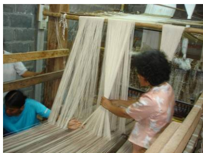
เริ่มเก็บตะกอลายที่ละไม้
