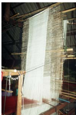
เริ่มเก็บตะกอลายที่ละไม้
