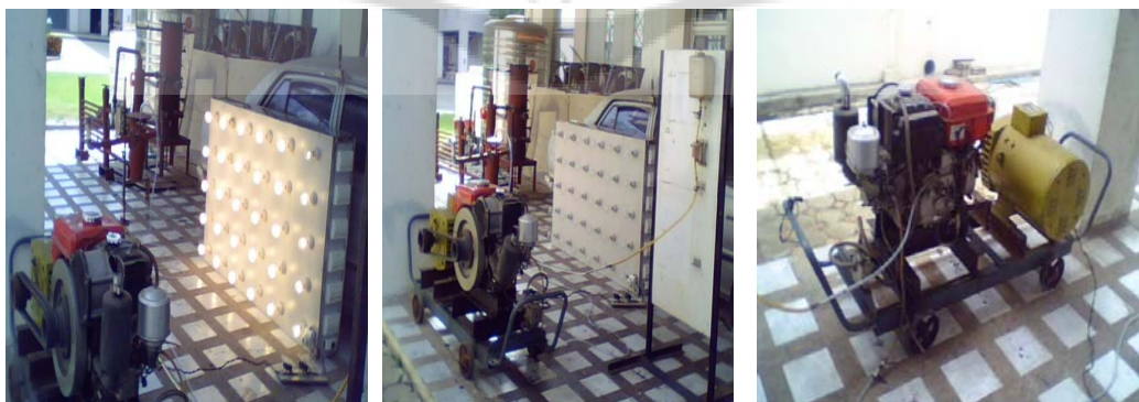
ภาพประกอบ 53 ภาพของระบบการผลิตก๊าซชีวมวล เครื่องยนต์ดีเซลขนาดเล็ก พร้อมเครื่องกำเนิดกระแสไฟฟ้า พร้อมอุปกรณ์
