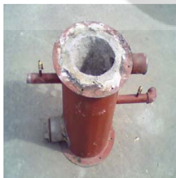
ภาพประกอบ 18 แสดงส่วนประกอบต่างของเตาผลิตก๊าซ ส่วน ของ Combustion และ Reduction Zone
