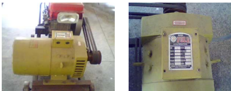
ภาพประกอบ 24 เครื่องกำเนิดไฟฟ้ากระแสสลับ ( Alternative Generator )
