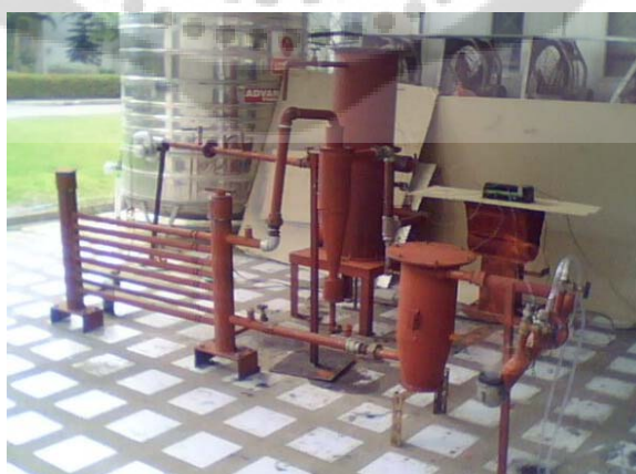
ภาพประกอบ 27 ชุดเตาผลิตก๊าซชีววมวลแบบไหลลง พร้อมอุปกรณ์ประกอบ ปริมาตรของเตาผลิตก๊าซ เท่ากับ 82 ลิตร เชื้อเพลิงน้ำหนัก 12 kg
