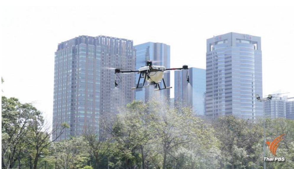
ภาพที่ 8-5 โดรนบรรทุกน้ำผสมสาร B9X ฉีดพ่นละอองน้ำขนาด 50 ไมครอน เพื่อจับฝุ่นละอองให้ตกลงสู่พื้นดิน
