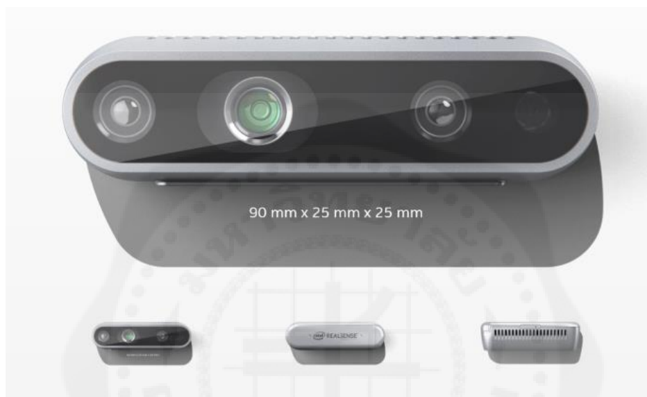
ภาพประกอบที่ 4 Intel Realsense D435
