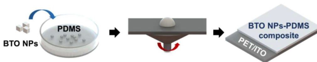
ภาพประกอบ 2.12 การแสดงแผนผังกระบวนการผลิตฟิล์มบางคอมโพสิต BTO NPs-PDMS [30]
