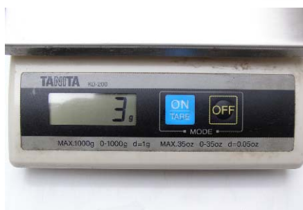
รูปที่ 4.1 ตราชั่งดิจิตอลความละเอียด 1 กรัม
