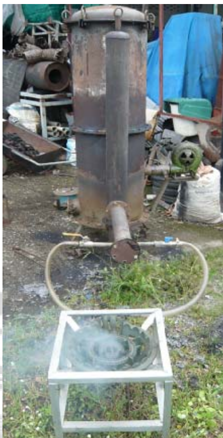
รูปที่ 3.1 เตาผลิตแก๊สชีววมวลเพื่อใช้ในการหุงต้ม
