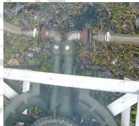
รูปที่ 4.11 การต่อท่อแก๊สเข้าหัวเตา
