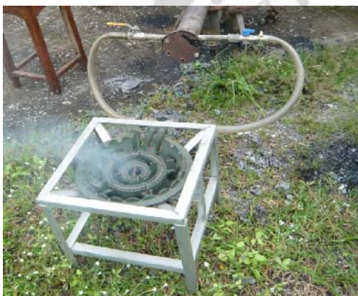
รูปที่ 4.10 การประกอบหัวเตาเข้าระบบ
