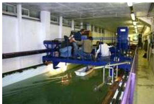
ภาพประกอบ 3 การทดลองลากเรือจำลองในถังลากเรือ
