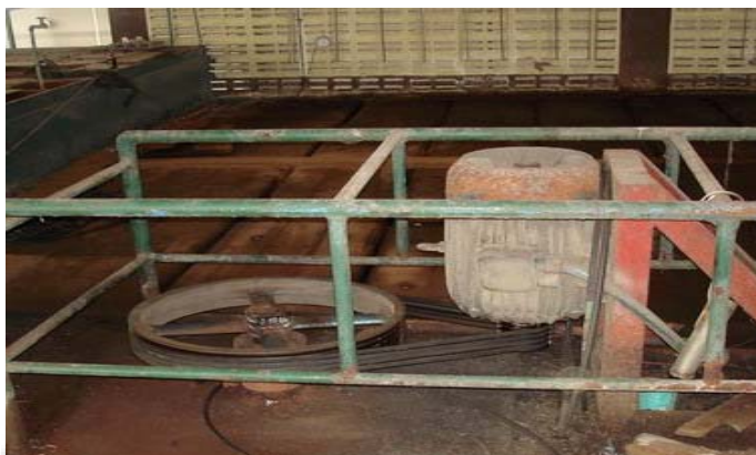
ภาพการใช้งานของสายพานหย่อนที่ชุดมอเตอร์กำลัง
