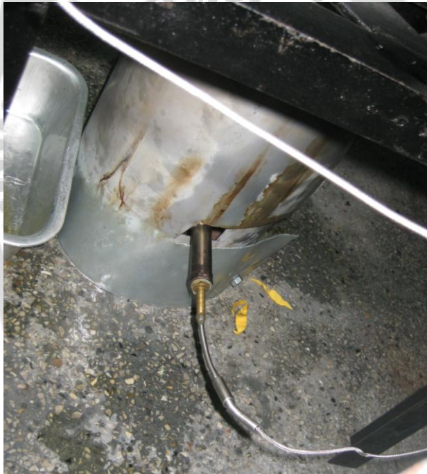
ภาพประกอบ 36 แสดงลักษณะการกัดกร่อนในกระบอกสูบ
