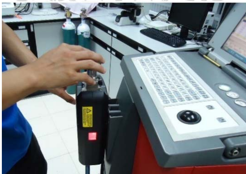
ภาพประกอบ 35 การนำชิ้นงานวางบนหัวยิง Spectro เพื่อตรวจสอบค่าส่วนประกอบ
