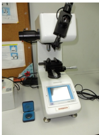
ภาพประกอบ 29 เครื่องทดสอบความแข็ง (Microhardness Tester: Future-Tech FM-700e)
