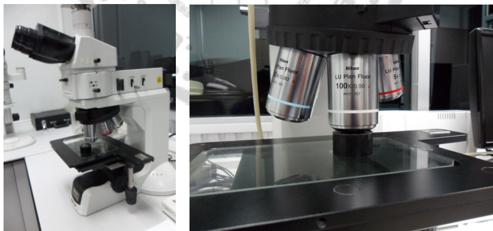
ภาพประกอบ 39 การวางชิ้นงานบนถาดรองชิ้นงานเพื่อถ่ายภาพโครงสร้างจุลภาค
