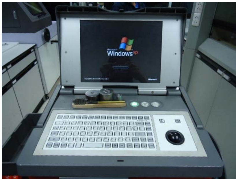
ภาพประกอบ 34 คอมพิวเตอร์เชื่อมต่อกับเครื่อง Spectrotest TXCO2 และอุปกรณ์สำหรับเตรียมผิว
