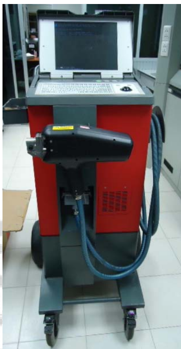
ภาพประกอบ 25 เครื่องวัดส่วนประกอบวัสดุ (Portable Optic Spectrometer : Spectro, Spectrotest TXCO2)
