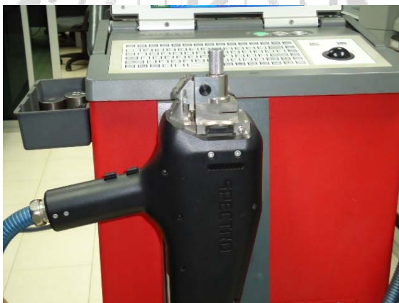
ภาพประกอบ 33 การสอบเทียบกับชิ้นงานมาตรฐานก่อนทดสอบกับชิ้นงานวิจัย
