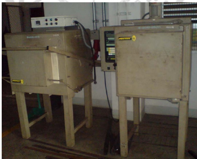
ภาพประกอบ 26 เตาอบเหล็กขนาดเล็ก Nabertherm N280E
