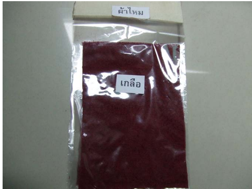
ภาพประกอบ 33 ผ้าไหมย้อมสีผสมสารช่วยติดชนิดเกลือ
