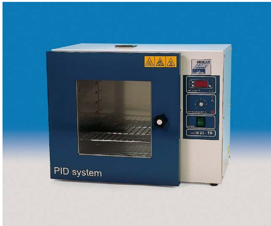
ภาพประกอบ 26 ตู้อบใช้ในการทดสอบความคงทนของสีต่อเหงื่อ
