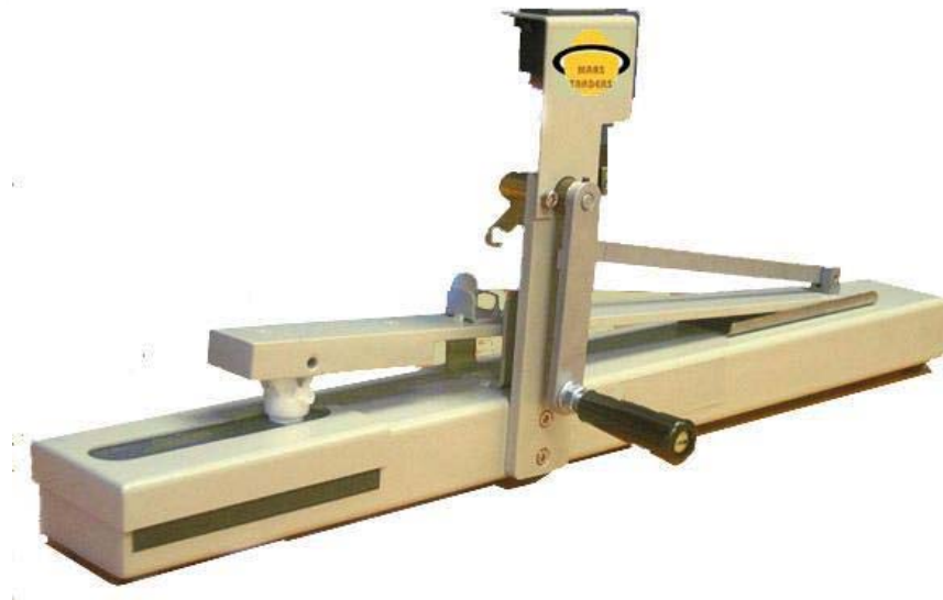
ภาพประกอบ 25 เครื่องทดสอบความคงทนของสีต่อการขัดถู
