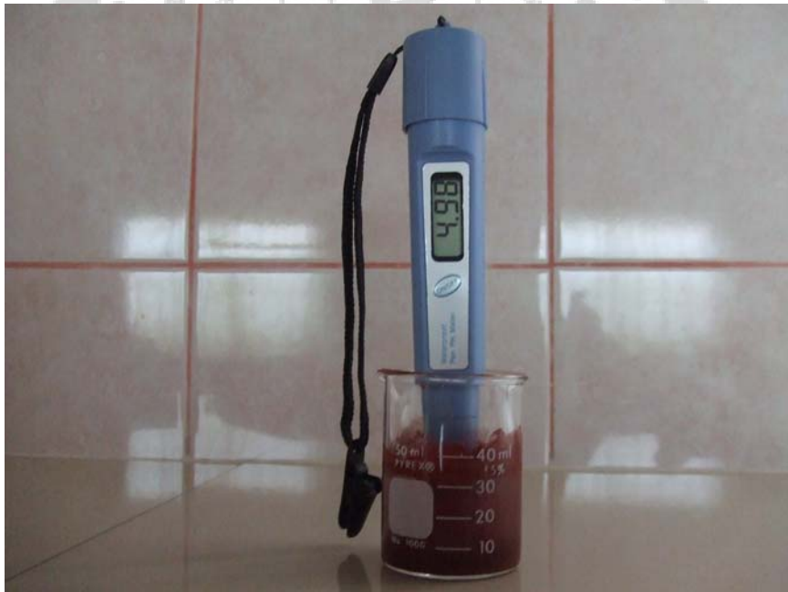
ภาพประกอบ 17 การวัดค่าพีเอชของเหล็กลอกไซด์ก่อนผสมสารช่วยติด
