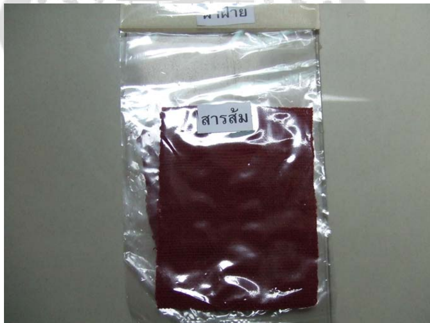
ภาพประกอบ 28 ผ้าฝ้ายย้อมสีผสมสารช่วยติดชนิดสารส้ม
