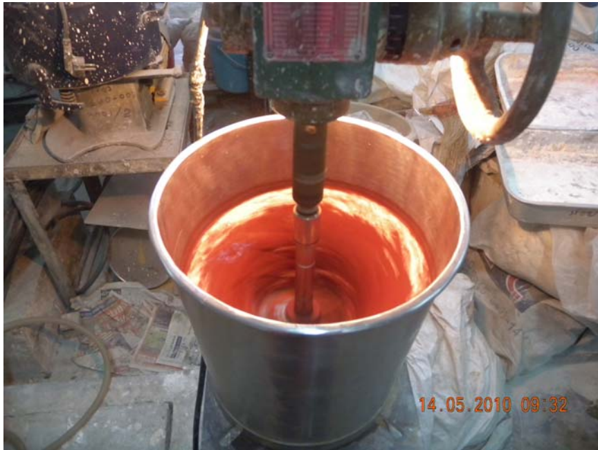
ภาพประกอบ 10 การผสมดินกับน้ำโดยเครื่องผสมดิน
