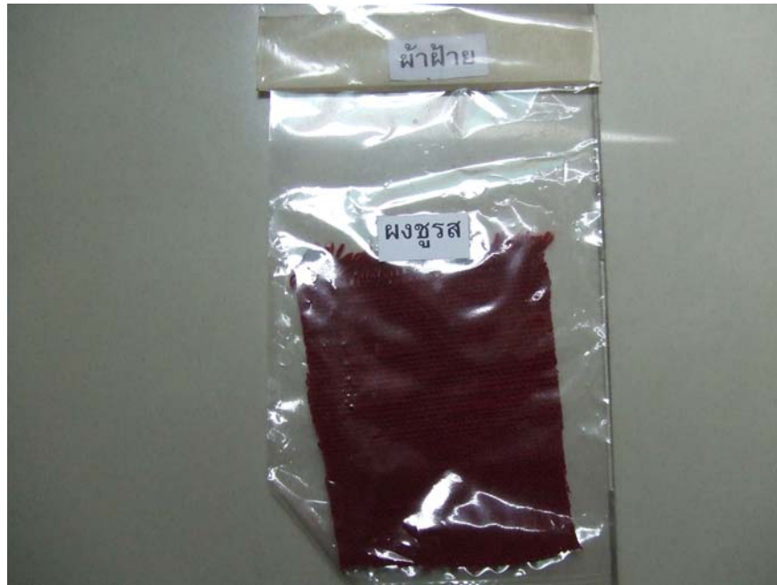
ภาพประกอบ 29 ผ้าฝ้ายย้อมสีผสมสารช่วยติดชนิดผงชูรส
