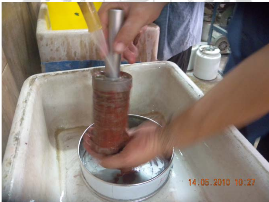
ภาพประกอบ 13 การนำแท่งเหล็กไหลผ่านน้ำเพื่อแยกเหล็กออกไซด์
