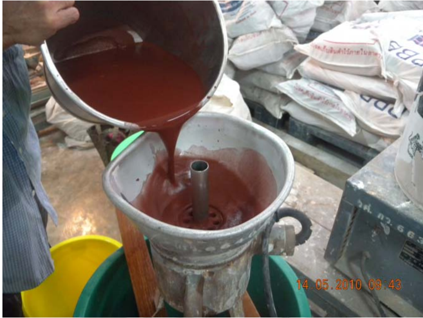
ภาพประกอบ 12 การแยกเหล็กออกไซด์ออกจากดินโดยเครื่องแยกเหล็กชนิดแม่เหล็กชั่วคราว
