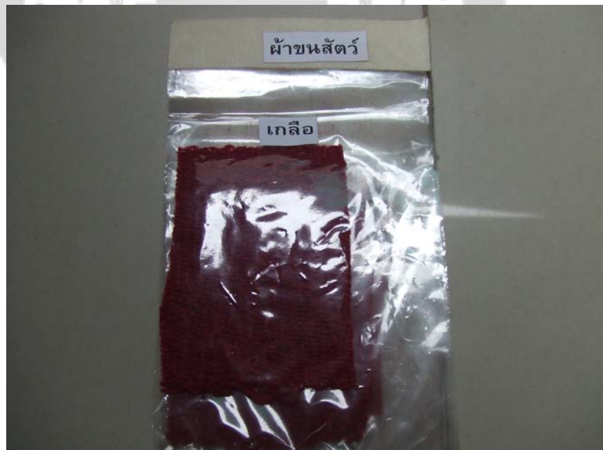
ภาพประกอบ 36 ผ้าขนสัตว์ย้อมสีผสมสารช่วยติดชนิดเกลือ
