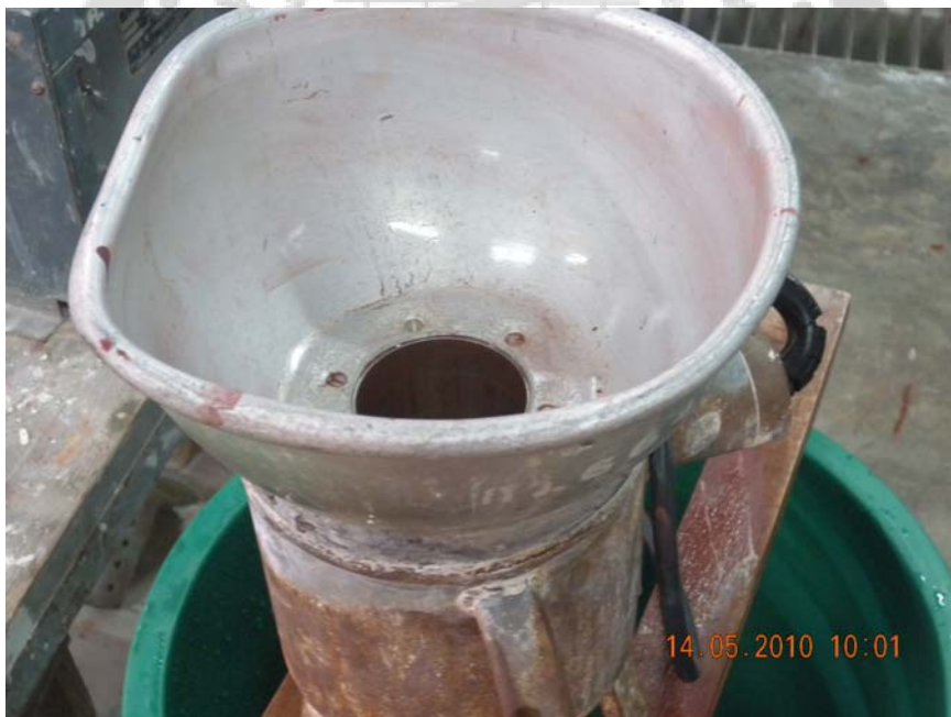
ภาพประกอบ 11 เครื่องแยกเหล็กชนิดแม่เหล็กชั่วคราว
