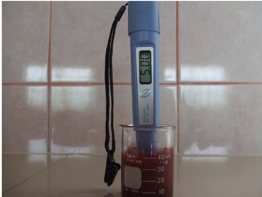
ภาพประกอบ 18 การวัดค่าพีเอชของเหล็กรอกไฮโดรเจลที่ผสมสารช่วยติด
