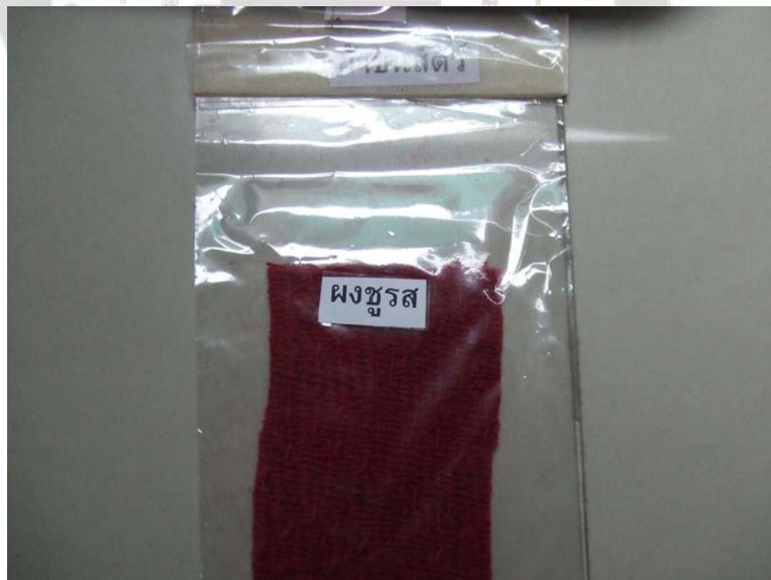
ภาพประกอบ 38 ผ้าขนสัตว์ย้อมสีผสมสารช่วยติดชนิดผงชูรส
