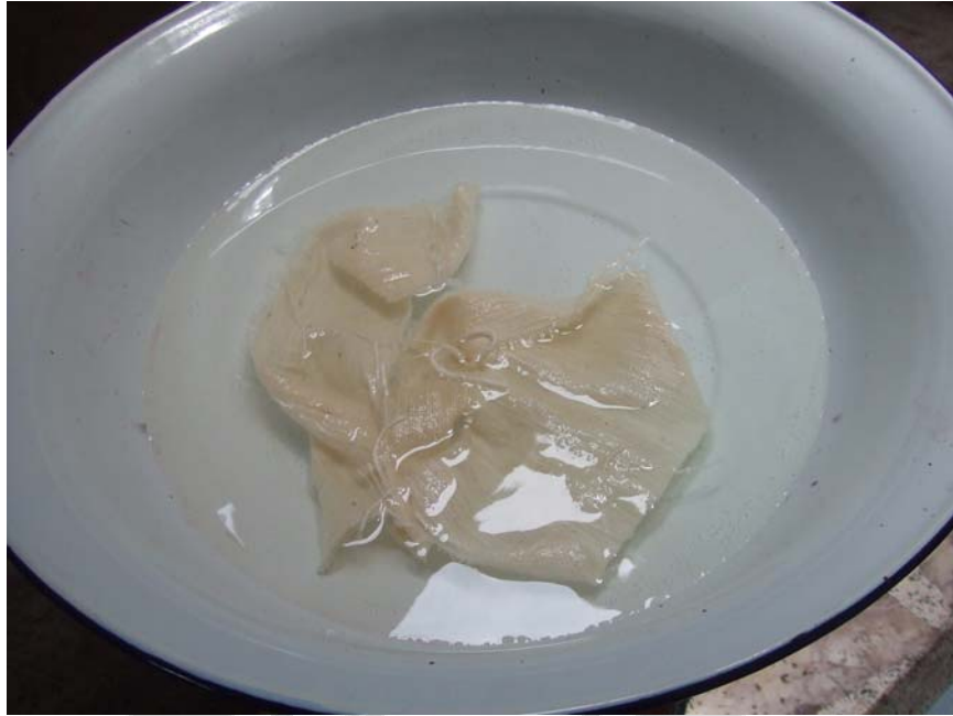
ภาพประกอบ 20 การแช่ผ้าในน้ำก่อนการย้อมสี
