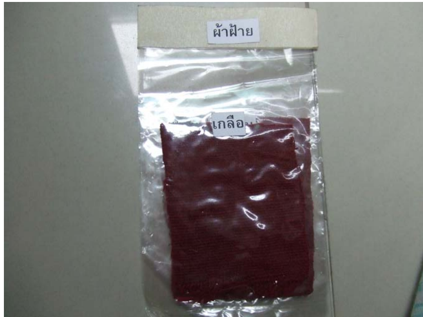
ภาพประกอบ 27 ผ้าฝ้ายย้อมสีผสมสารช่วยติดชนิดเกลือ
