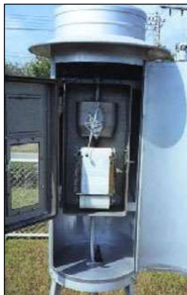
รูปที่ 2.3 เครื่องวัดน้ำฝนแบบอัตโนมัติ
