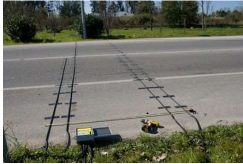
รูปที่ 2.9 เครื่องนับแบบท่อความดัน (Pneumatic road tube) (ที่มา: http://around-fct.weebly.com/fieldwork.html )
