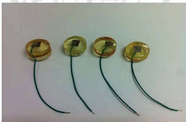
ภาพประกอบ 14 แผ่นไทเทเนียมติดกับสายไฟเมื่อแกะออกจากแม่แบบหล่อเรซิน
