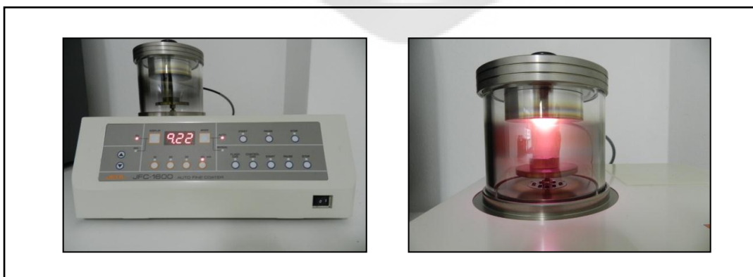
ภาพประกอบ 11 การนำชิ้นตัวอย่างไปผ่านขั้นตอนการเคลือบทอง
