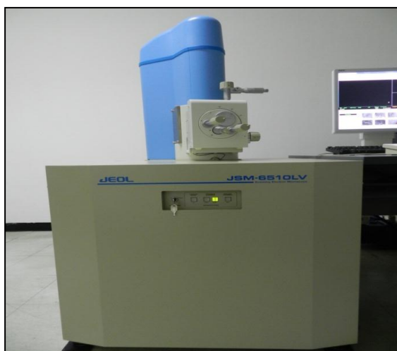
ภาพประกอบ 12 กล้องจุลทรรศน์อิเล็กตรอนแบบส่องกราด
