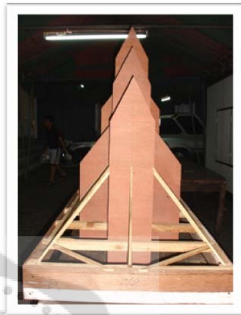
ภาพประกอบ 71 การเตรียมโครงสร้างของฝาลองสำเร็จเรียบร้อย
