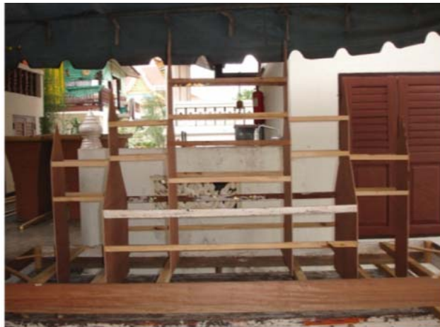
ภาพประกอบ 33 โครงสร้างฝาโลง ด้านข้าง
