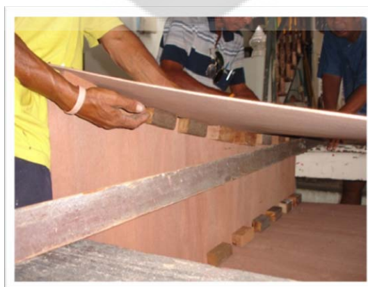
ภาพประกอบ 75 การเข้าไม้ ตัวโลงต้องใช้ความชำนาญทางเชิงช่างมาก เนื่องจากส่วนประกอบทุก ส่วนต้องประกอบกันได้แนบสนิทพอดี และรูปทรงของตัวโลงต้องสวยงามตามรูปแบบ
