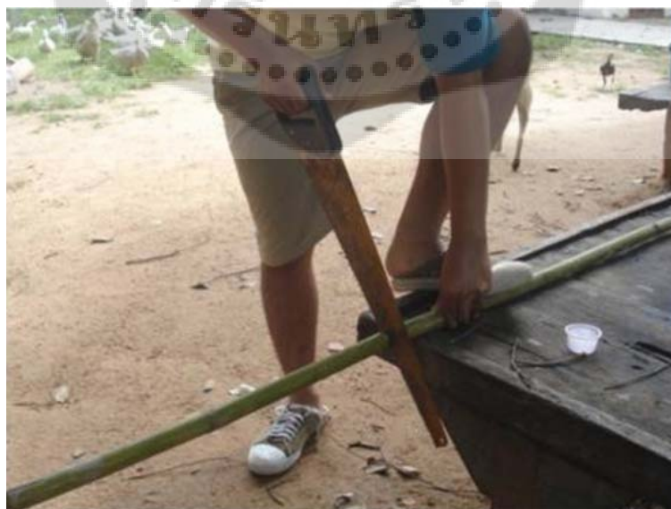
ภาพประกอบ 66 นำไม้ไผ่ลวกมาตัดให้ได้ขนาดเพื่อทำแกนโหวด
