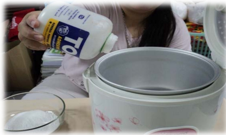
ภาพประกอบ 39 นำกาวลาเทคมาใส่หม้อตั้งไฟให้เดือด
