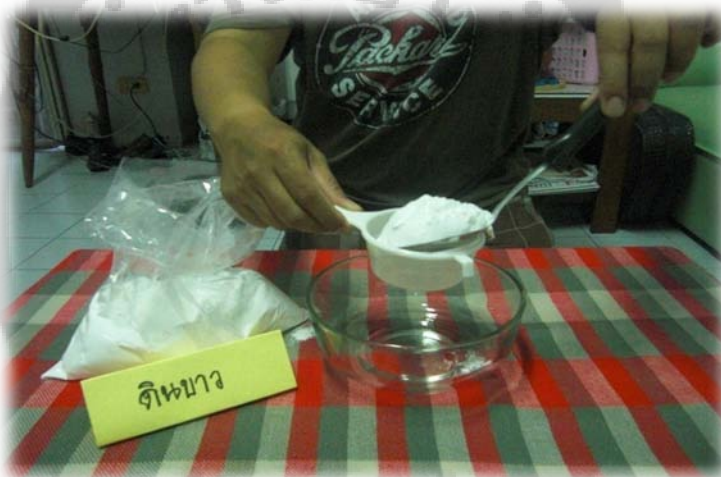
ภาพประกอบ 24 ร่อนดินขาวด้วยตะแกรง
