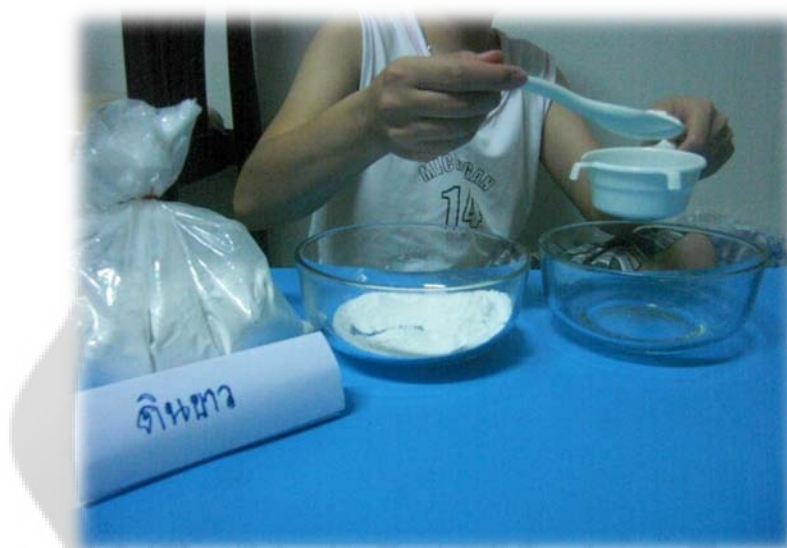
ภาพประกอบ 8 ร่อนดินขาวด้วยตะแกรง
