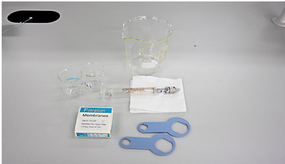
ภาพประกอบ 38 ชุดกรองที่ใช้ในการกรองสารมาตรฐานและสารตัวอย่างก่อนนำไปฉีดเข้าสู่ระบบโครมาโทกราฟีของเหลวสมรรถนะสูง
