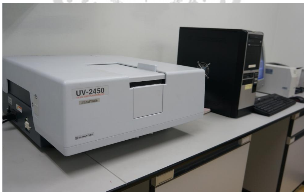
ภาพประกอบ 41 เครื่องยวี่ วิสิเบิล สเปกโตรโฟโตมิเตอร์
