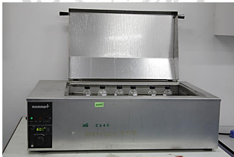
ภาพประกอบ 37 เครื่องอังน้ำที่สามารถควบคุมอุณหภูมิได้ใช้ในการให้ความร้อนในการเตรียมอนุพันธ์
