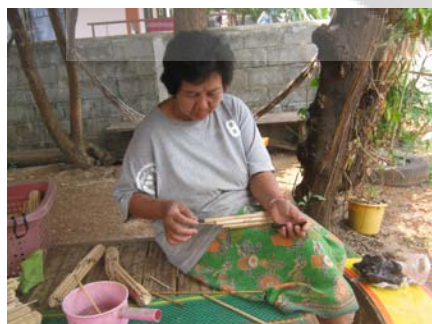
ภาพประกอบ 53 ขูดรูโหวด และเทียบเสียงตามไม้แบบ
