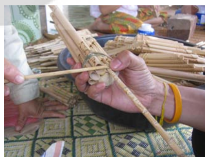
ภาพประกอบ 53 ขูดรูโหวด และเทียบเสียงตามไม้แบบ
