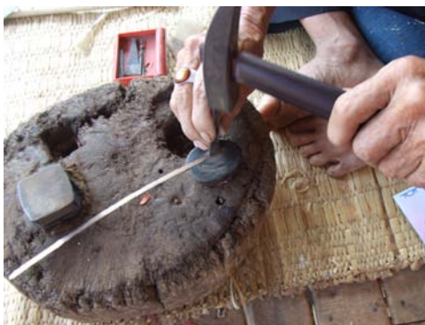
ภาพประกอบ 36 นำหلابโลหะมาสับ
