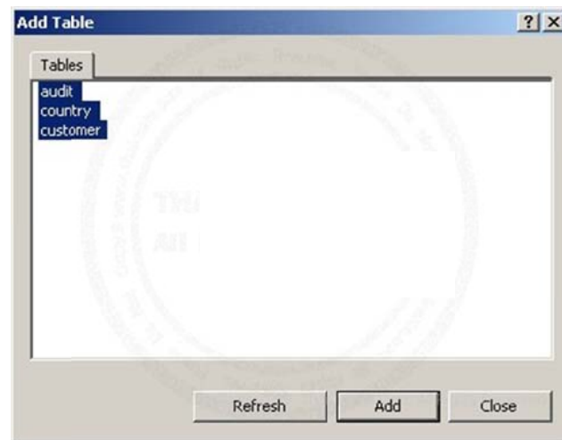
ภาพประกอบ 11 การเพิ่มตารางฐานข้อมูลเข้ามาใน Diagram เพื่อสร้างความสัมพันธ์
