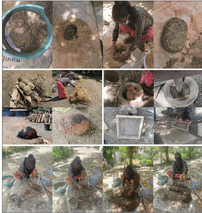
ภาพที่ 2 ภาพการทำดินเชื้อโดยการนำดินเหนียวมาผสมกับแกลบแล้วปั้นเป็นรูปวงรีทรงแบนและผากกลางแจ้งจากเศษกิ่งไม้และฟางจนก่อนดินสุก ต้มาก่อนดินเชื้อแล้วร่อนจนละเอียดก่อนนำไปผสมเนื้อดินปั้นตามภาพ ที่มา : ภาพถ่ายโดยผู้วิจัย เมื่อวันที่ 30 เมษายน 2564
