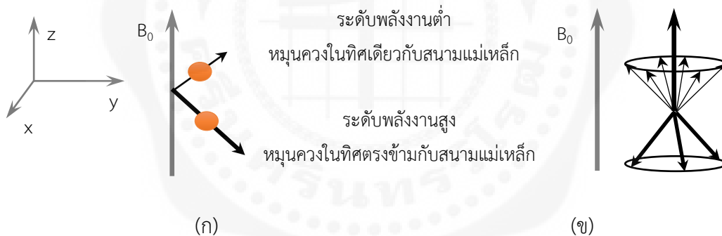
รูปที่ 7.10 ระดับพลังงานและสภาพแม่เหล็กของนิวเคลียร์สปิน (ก) นิวเคลียร์สปินสามารถหมุนในทิศเดียวหรือในทิศตรงข้ามกับสนามแม่เหล็ก B_0 (ข) ผลรวมของสภาพแม่เหล็กมีค่าในทิศเดียวกับสนามแม่เหล็กหลัก เวกเตอร์ที่ยาวและหนากว่าแสดงถึงระดับพลังงานที่มากกว่า
