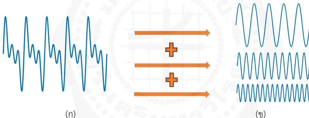
รูปที่ 4.1 การแยกแยะสัญญาณในแต่ละช่วงความถี่
