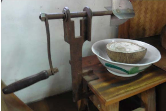
ภาพที่ ๖ เครื่องขูดมะพร้าว (ที่มา: นันทพัชร น้อยสวัสดิ์, ๒๕๖๑)
