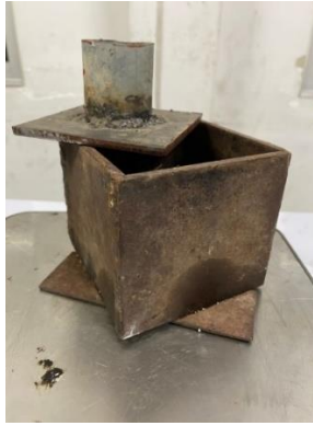
ภาพที่ 2 รูปชิ้นงานหัวกระจายแรง และแบบเหล็กสำหรับขึ้นรูปชิ้นงาน
